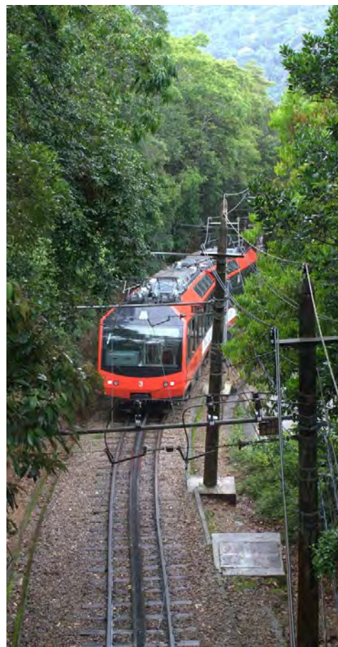
Estrada de Ferro do Corcovado, no Rio de Janeiro, que vence 710 metros em 3,8 km de extensão, através do sistema cremalheira aderência. Em 1910 foi a primeira linha de trem eletrificada no Brasil. Foto da autora.
