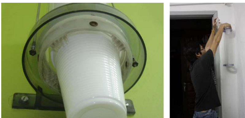
FIGURA 1.12 – Superfície com filamentos utilizada para separação de copos e problema de altura para reabastecimento da dispensadora. Acervo pessoal.
