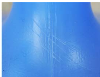
Figura 1.9 – Danos decorrentes das dificuldades de remoção da tampa. Acervo pessoal
