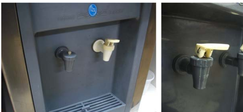
Figura 2.14 – Torneiras com a chave de acionamento danificada. Acervo pessoal.
