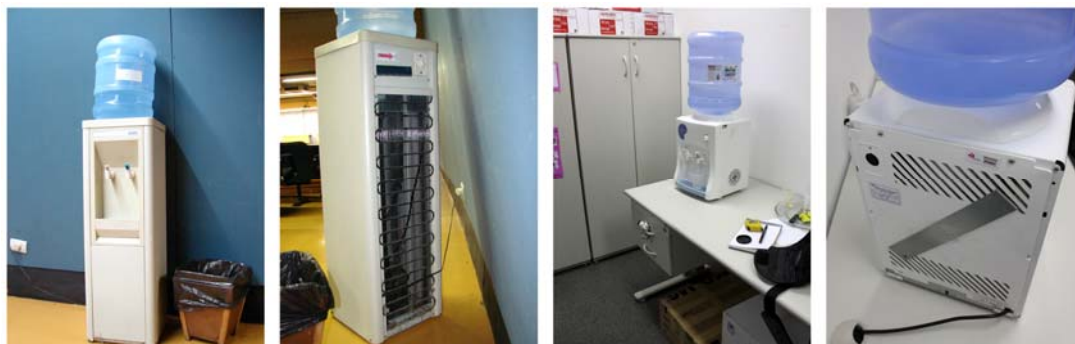
Figura 2.1 – Algumas variações de bebedouro. Modelo de coluna com refrigeração mecânica e modelo de mesa com refrigeração termoelétrica. Acervo pessoal.
