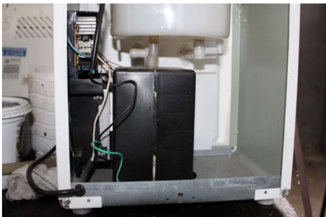
Figura 2.10 – Reservatório com refrigeração termoelétrica. Acervo pessoal.
