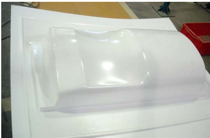
Figura 9.8 – Peça em que não se formou o vácuo. Acervo pessoal.
