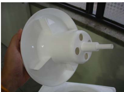
Figura 2.7 – Modelo de funil separador e demonstração do funcionamento.
