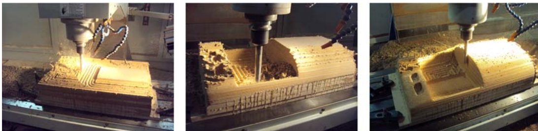
Figura 9.4 – Processo de usinagem dos moldes. Fonte: Adriano de Luca.
