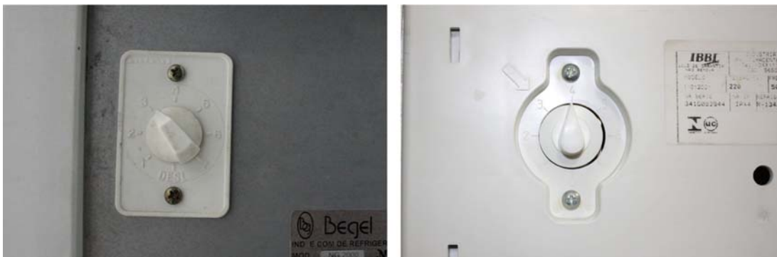
Figura 2.20 – Mostradores possuem pouco contraste e podem levar a interpretação ambígua.
