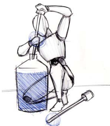
Figura 8.11 – Riscos de contato detectados na instalação do tubo coletor.
