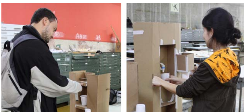
Figura 8.25 – Testes de posicionamento dos comandos do produto. Acervo pessoal.
