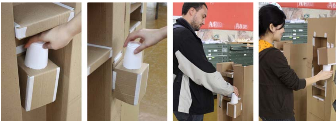
Figura 8.24 – Testes de retirada de copos: falta de espaço no dispensador embutido e mudança para posicionamento mais acessível; retirada de copos de ponta-cabeça e na posição correta. Acervo pessoal.
