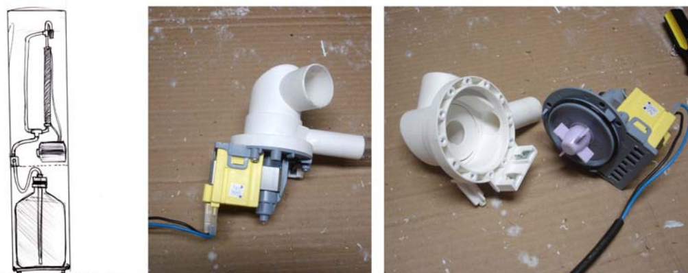
Figura 8.8 – Sistema de retirada de água por bombeamento e exemplo de bomba centrífuga. Acervo pessoal.
