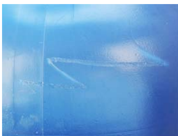
Figura 1.9 – Danos decorrentes das dificuldades de remoção da tampa. Acervo pessoal
