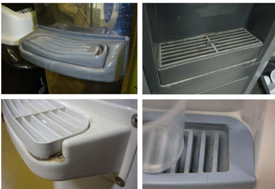
Figura 2.17 – Problemas de higiene decorrentes do excesso de reentrâncias da pingadeira. Acervo pessoal.
