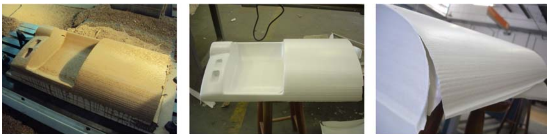
Figura 9.5 – Molde logo após a usinagem, e peças de teste, refletindo as imperfeições do molde. Acervo pessoal.
