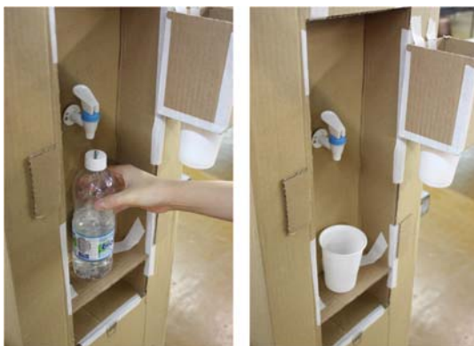
Figura 8.26 – Ajuste de vão entre torneira e pingadeira. Acervo pessoal.
