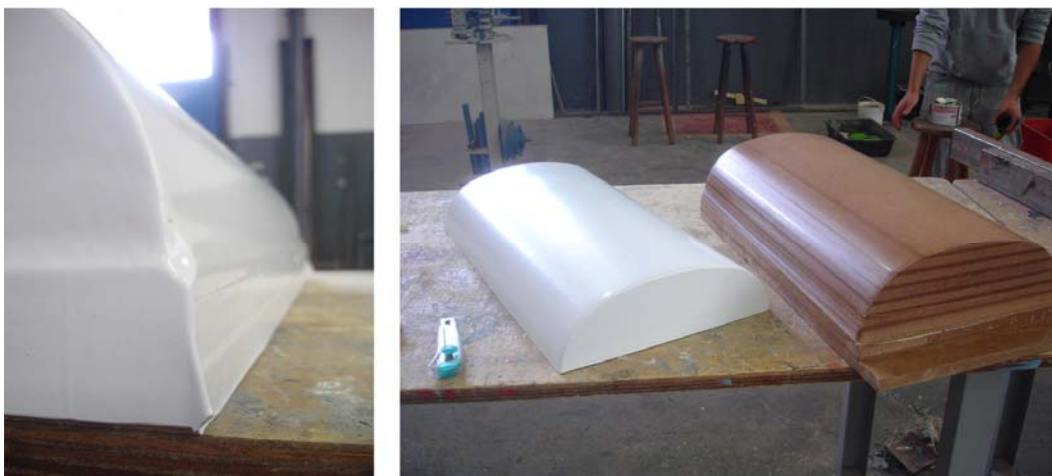
Figura 9.10 – Imperfeição do processo de usinagem e peça refilada. Acervo pessoal.
