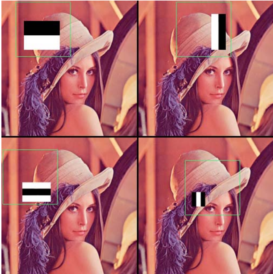
Figura 2-6: Varredura de uma imagem em busca de padrões baseado na diferença entre áreas claras e escuras de uma região.
