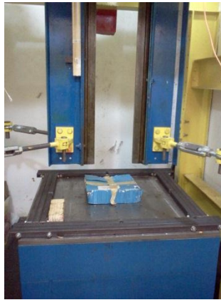
Figura 58 – Máquina para o ensaio de impacto
