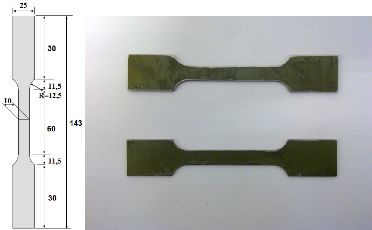
Figura 39 – Corpos de prova para o teste estático
