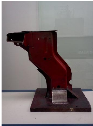
Figura 59 – Longarina cortada e fixada
