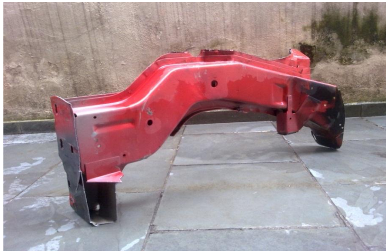
Figura 35 – Longarina do lado do passageiro (vista interna ao compartimento do motor)
