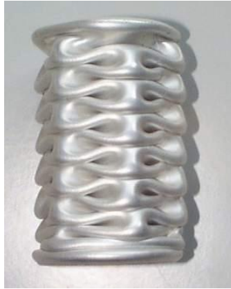
Figura 10 – Fenômeno de autocontato em um tubo cilíndrico (GMSIE, 2012)
