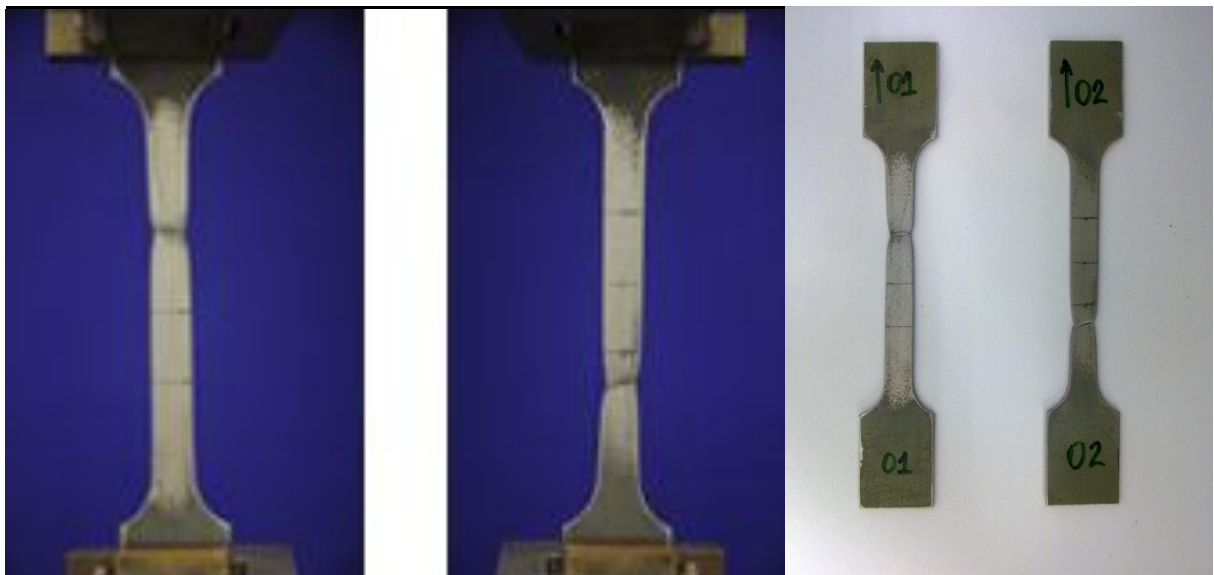
Figura 41 – Corpos de prova ao final do ensaio estático
