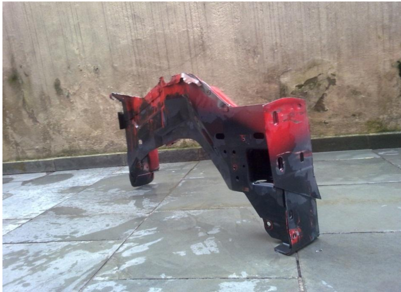
Figura 37 – Longarina do lado do passageiro (vista externa ao compartimento do motor)
