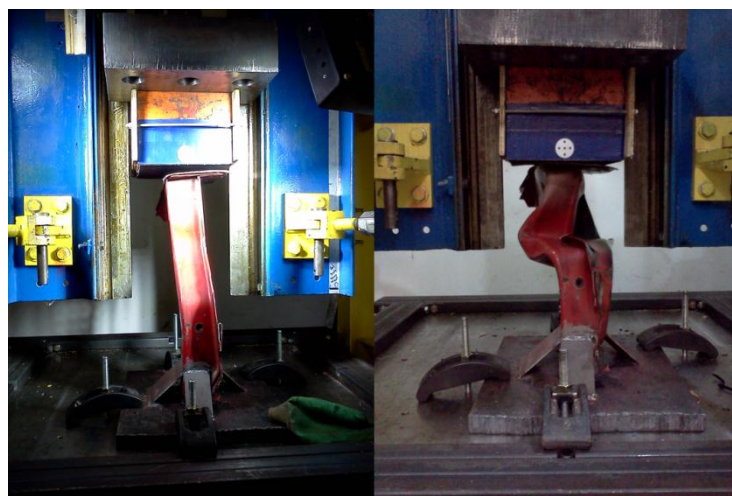
Figura 61 – Longarina antes e depois do ensaio de impacto
