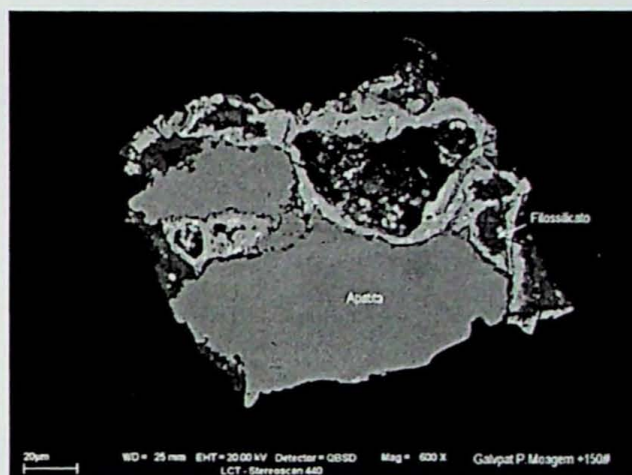
Foto 16 - Amostra: Galv-Pat, produto de moagem, + 150 #. Grão típico de apatita envolto por uma película de óxido de Fe, além da presença de um filossilicato.
