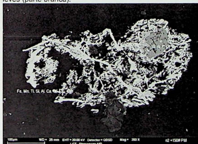
Foto 11 - Amostra: P-120, produto de moagem, + 65 #. Películas de óxido-hidróxido de Fe e Mn (nuvem clara na foto) em volta de um feldspato (indicado pelo número 2 ).
