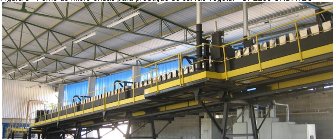
Figura 3 - Forno de micro-ondas para produção de carvão vegetal - UPE250 ONDATEC®
