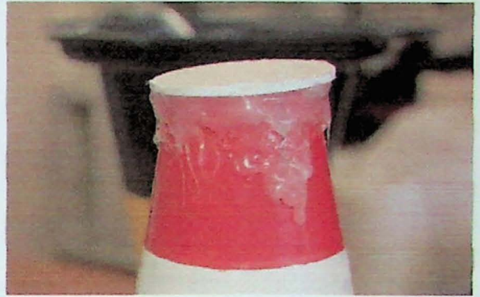
Figura 4. Base menor colada com folha de PVC.
