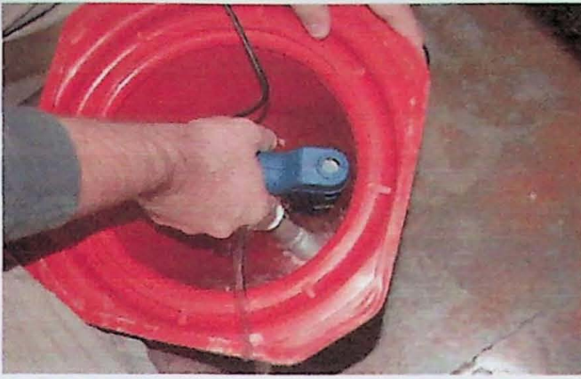
Figura 9. Filtro sendo colado com silicone quente dentro do cone de PE.
