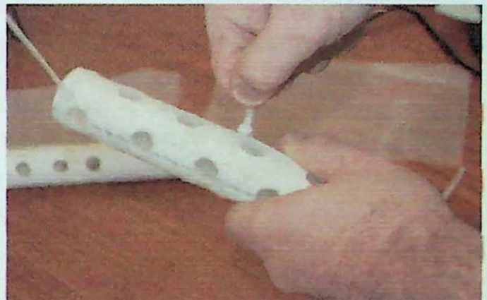
Figura 6. Fixação da tela com braçadeiras.
