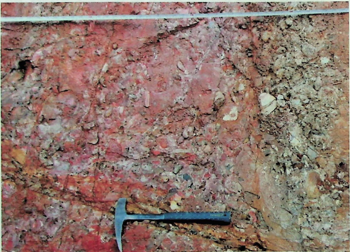
Fig. 4.2.4 – Obtenção de fotografias no afloramento IPM 01. A trena representa a linha horizontal (direção da seção), o cabo do martelo representa o azimute da direção, pela regra da mão direita, e o bico do martelo representa o rumo do mergulho.
