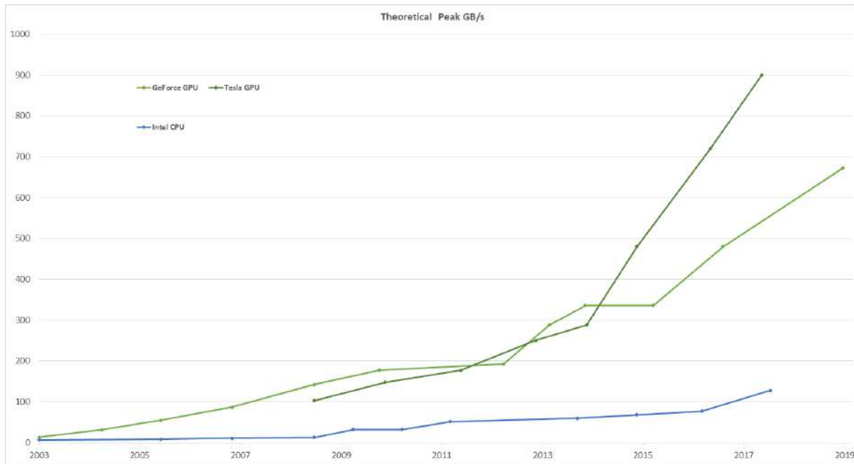
Figura 2: Comparativo entre largura de banda de memória em CPU e em GPU.
