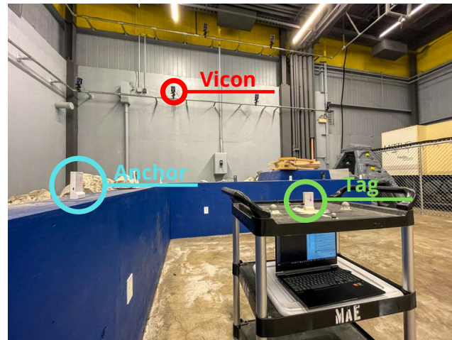
Figura 25 – Experimento montado nas dependências da West Virginia University para mover uma TAG (verde) dentro de uma rede de âncoras (azul) para comparar com o sistema Vicon (vermelho). O carro usado é holonômico, permitindo movimentos em qualquer direção sem alterar a orientação da TAG.
