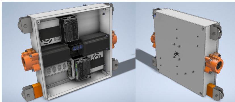
Figura 9 – Protótipo do robô para a Arquitetura de Polias móveis. É possível ver a organização interna com moteres, fontes de alimentação, drivers de controle e um computador central com uma câmera. As polias presentes guiam o cabo até o mecanismo de tração.
