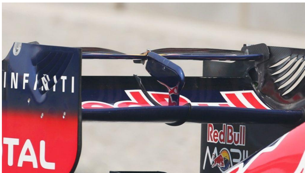
Imagem 5 - Asa traseira de um veículo de Formula 1 com o DRS ativado
