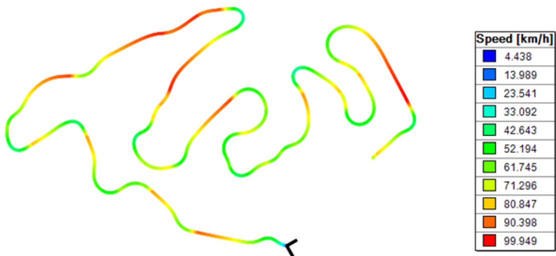
Imagem 13 - Resultado da simulação com DRS para autocross
