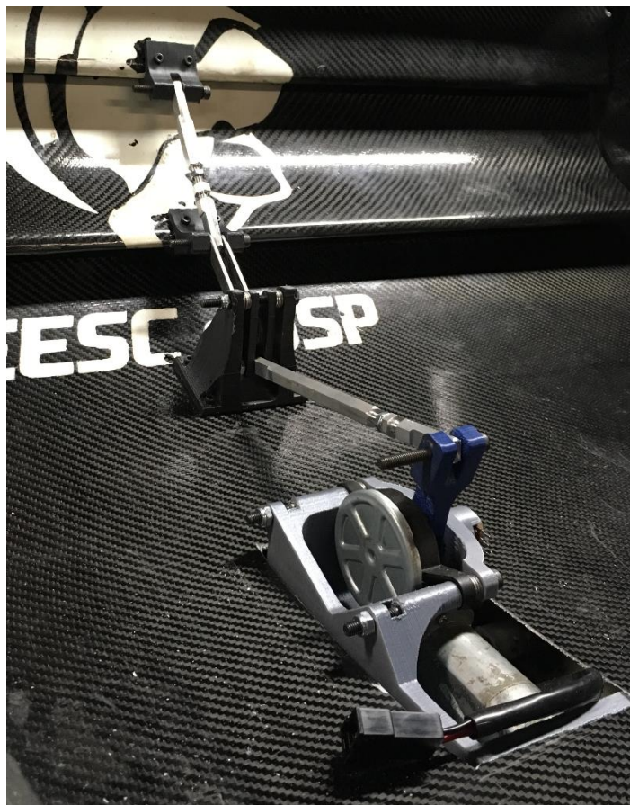
Imagem 32 - Mecanismo posicionado na asa traseira do protótipo E13
