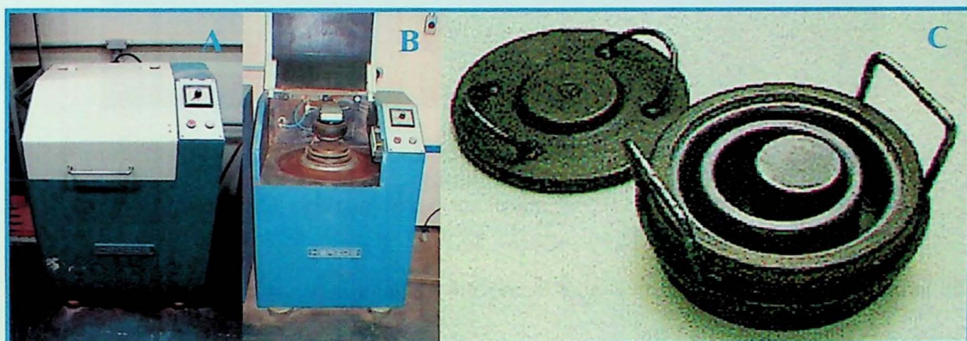
Figura 18: Moinho de anéis (A e B); panela de carbeto de tungstênio utilizada para a moagem das amostras destinadas à Fluorescência de Raios-X (C).
