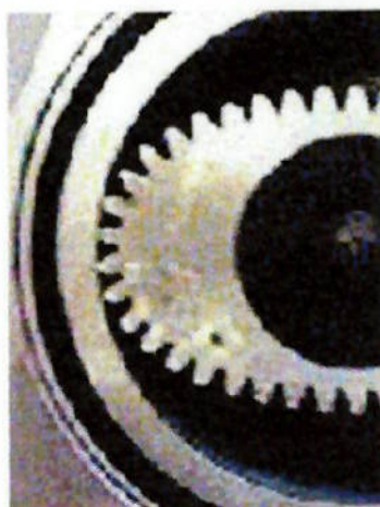
Figura B12 - Folga entre os dentes e a engrenagem.
