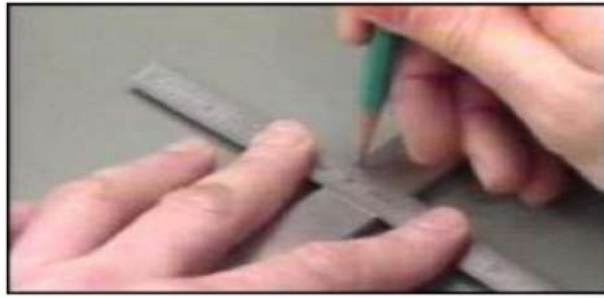
Figura 15: Marcar com um lápis a posição que se deseja colar o extensômetro.
