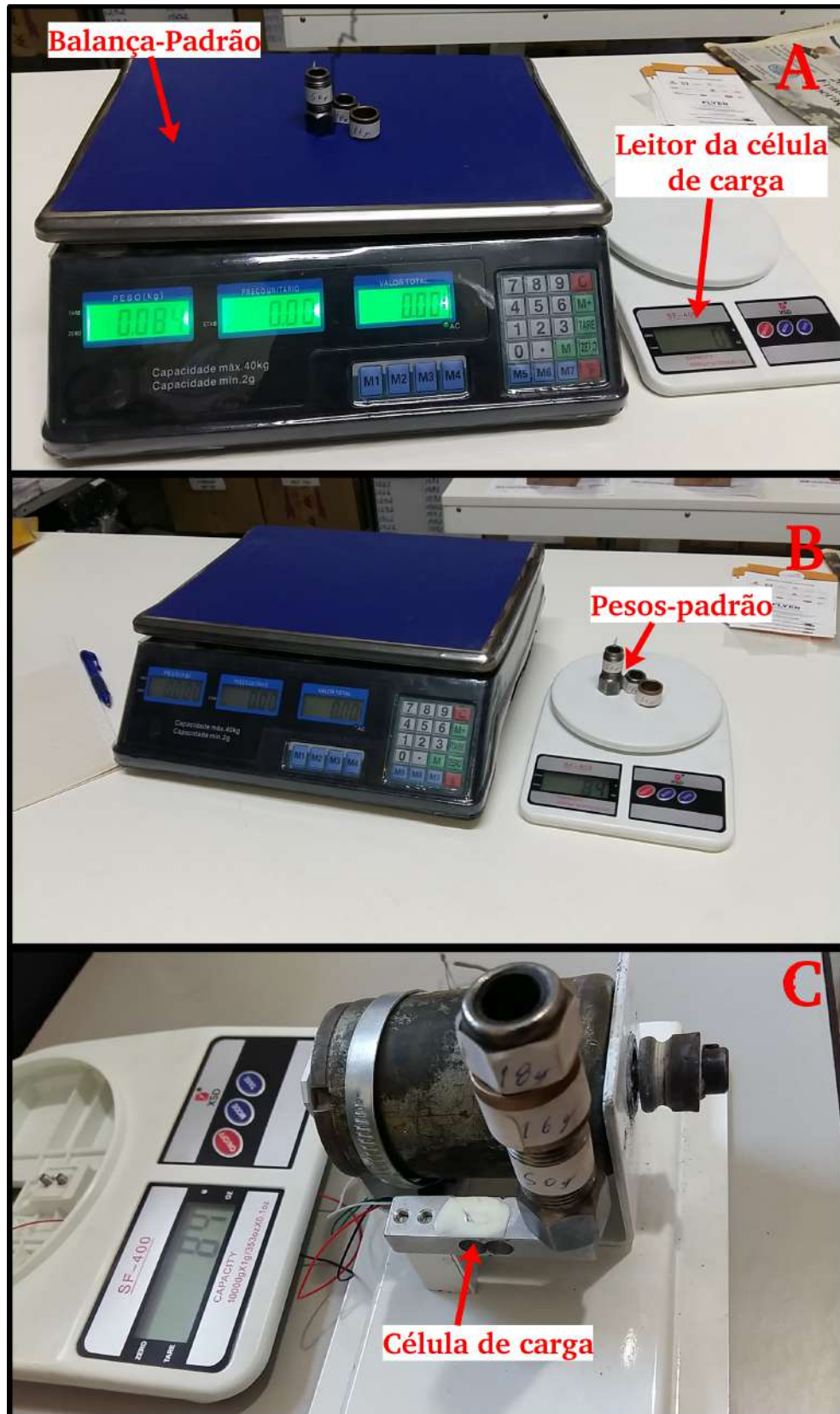
Figura 32: Comparação das medidas entre balança de referência e leitor da célula de carga do dinamômetro: em (A) Pesos-padrão são aferidos em balança de referência, em (B) valor dos pesos são conferidos em balança utilizada como leitor de célula de carga do dinamômetro; em (C) Leitor de célula de carga é aferido com os pesos-padrão
