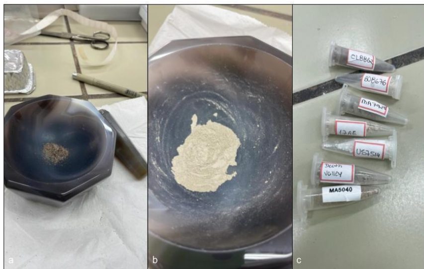
Figura 7: Ilustração dos equipamentos utilizados na preparação das amostras para análise de Difração de Raios X. a) Fração de areia no almofariz de ágata; b) moagem até a fração virar pó; c) armazenamento das amostras.
