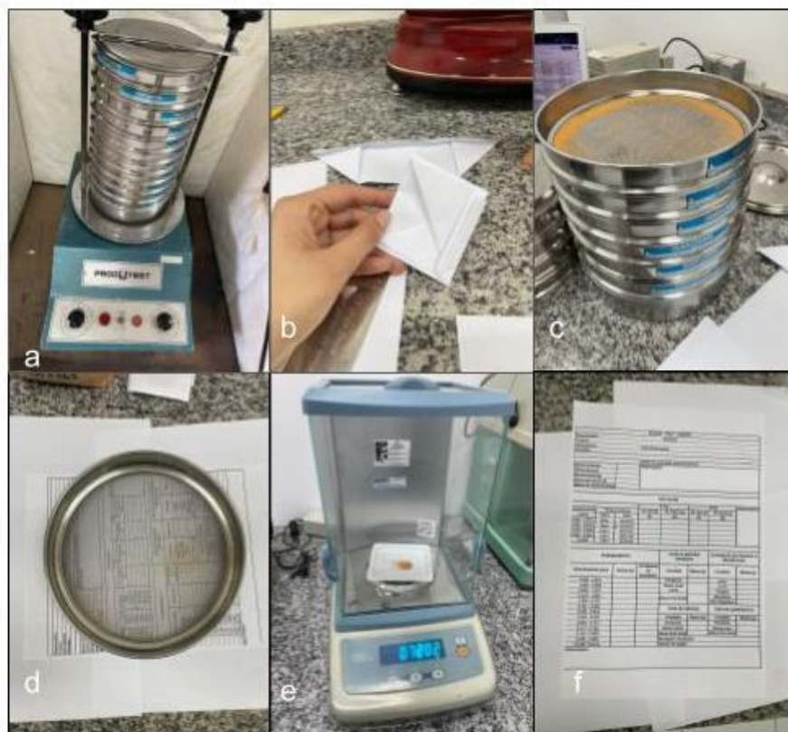
Figura 6: Ilustração dos equipamentos utilizados na análise granulométrica por peneiramento. a) peneiras acopladas a caixa para amortecimento de ruídos e vibrações; b) preparação dos envelopes para armazenamento das amostras; c) conjunto de peneiras; d) retirada das frações retidas em cada peneira; e) balança analítica; f) ficha utilizada.
