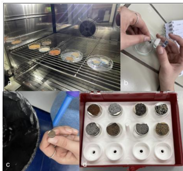
Figura 8: Ilustração dos equipamentos utilizados na preparação das amostras para a Microscopia Eletrônica de Varredura X. a) Amostras na estufa; b) Amostra sendo fixada nos stubs; c) Tirando os grãos soltos do stub; d) Amostras preparadas.
