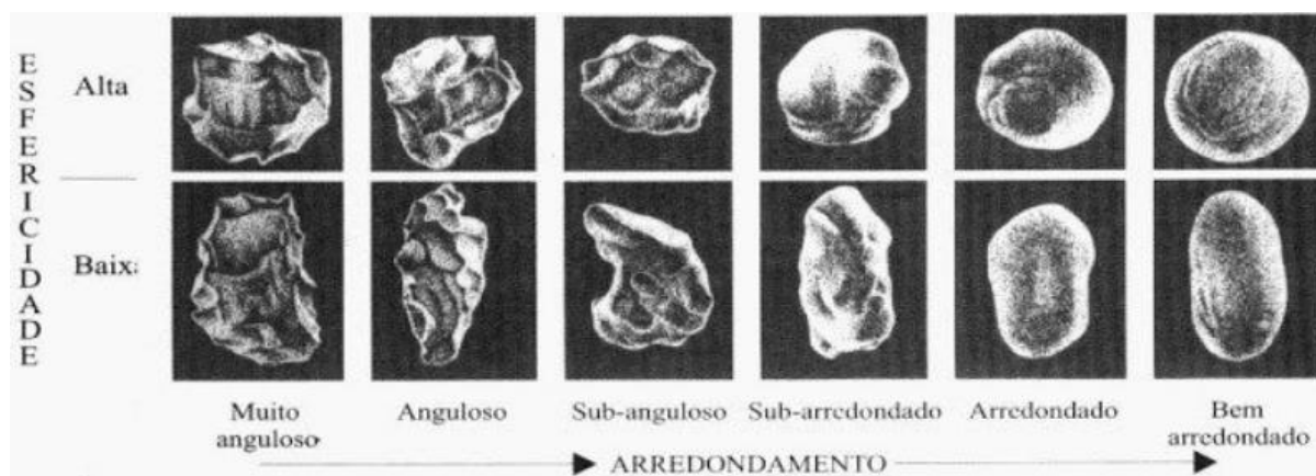
Figura 19: Esfericidade - Grau de arredondamento. Fonte: Suguio, 1980.
