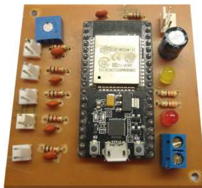
Figura 32 – Placa de sensoriamento implementada
