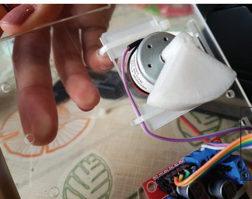
Fig 44 a 47. Processo de desenvolvimento do núcleo, passando pela soldagem, montagem da caixa preliminar e colocação do excêntrico
