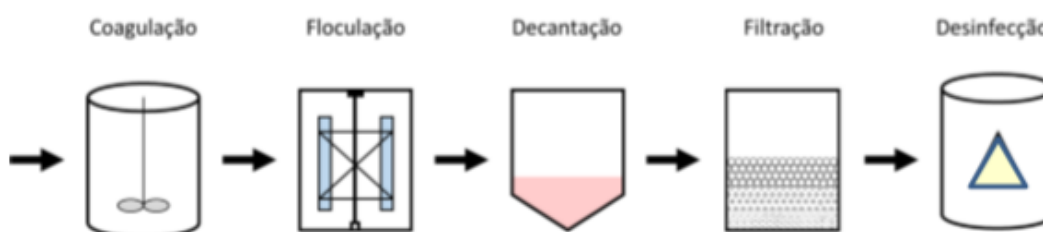
Figura 2 - Fluxograma do processo de tratamento convencional de água para abastecimento
