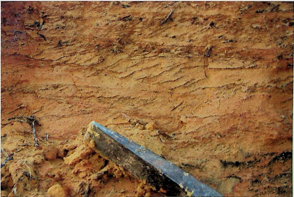
Foto 07-02 Interlaminado (intercalação entre arenito fino e siltito argiloso).
