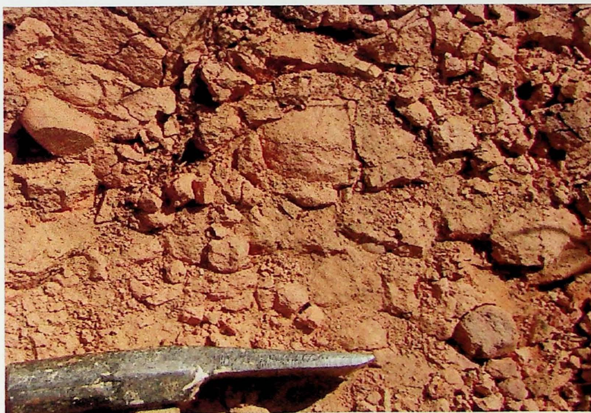
Foto 30-02 Diamictito silto-arenoso alterado, com clastos subarredondados variando de milimétricos a centimétricos.
