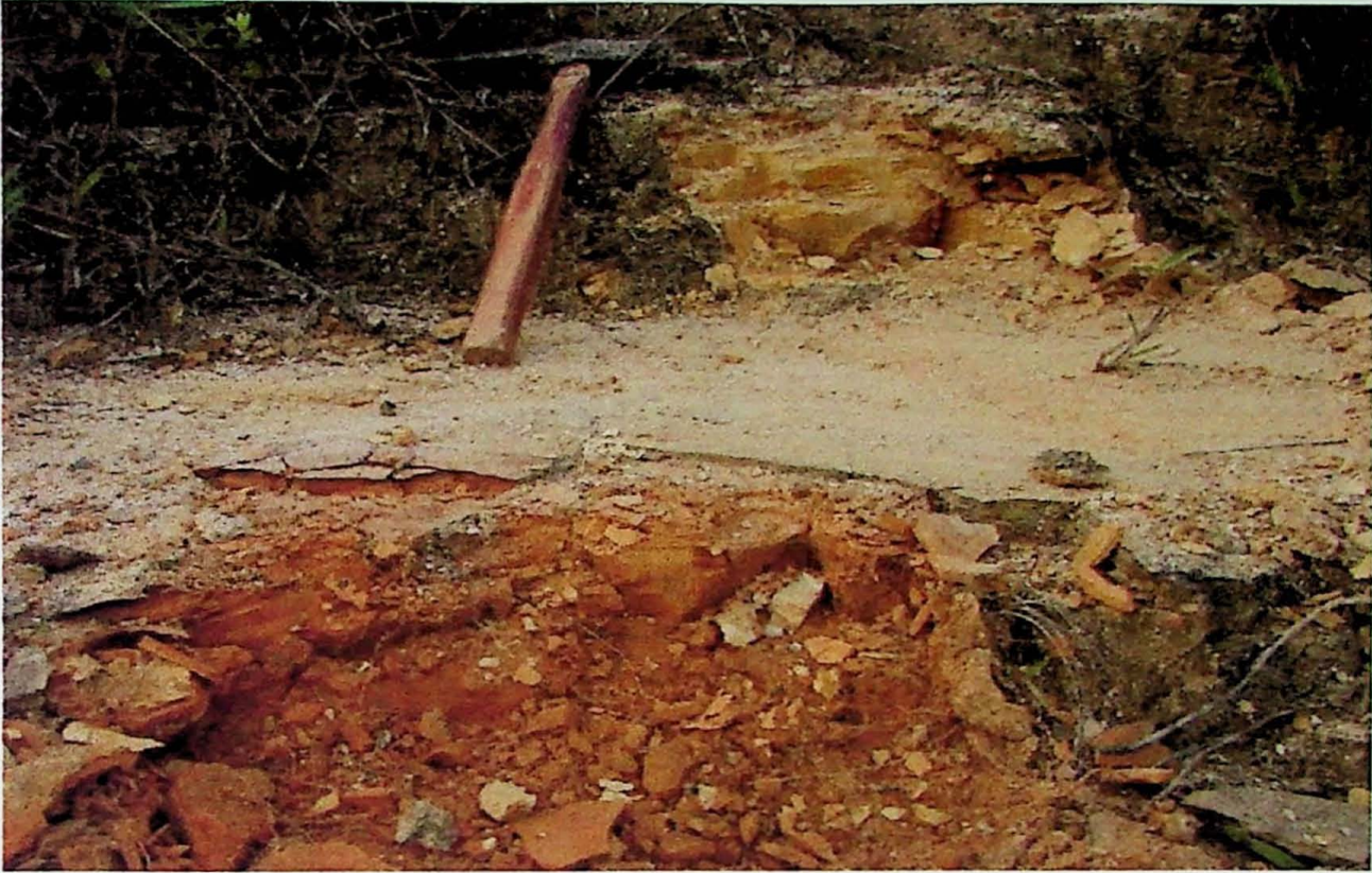
Foto 26-03 Crosta limonítica, com cerca de 1 cm de espessura.
