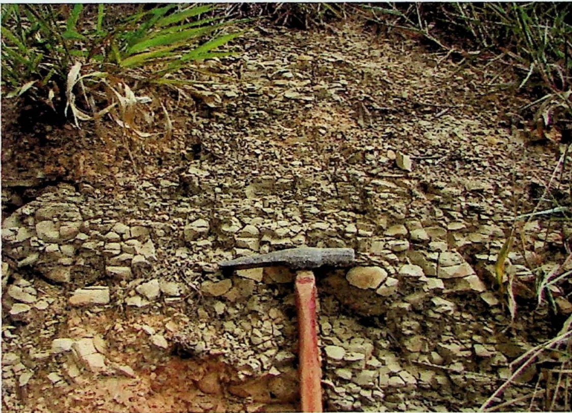
Foto 28-01 Intercalação entre siltito de matriz argilosa e siltito de matriz arenosa.
