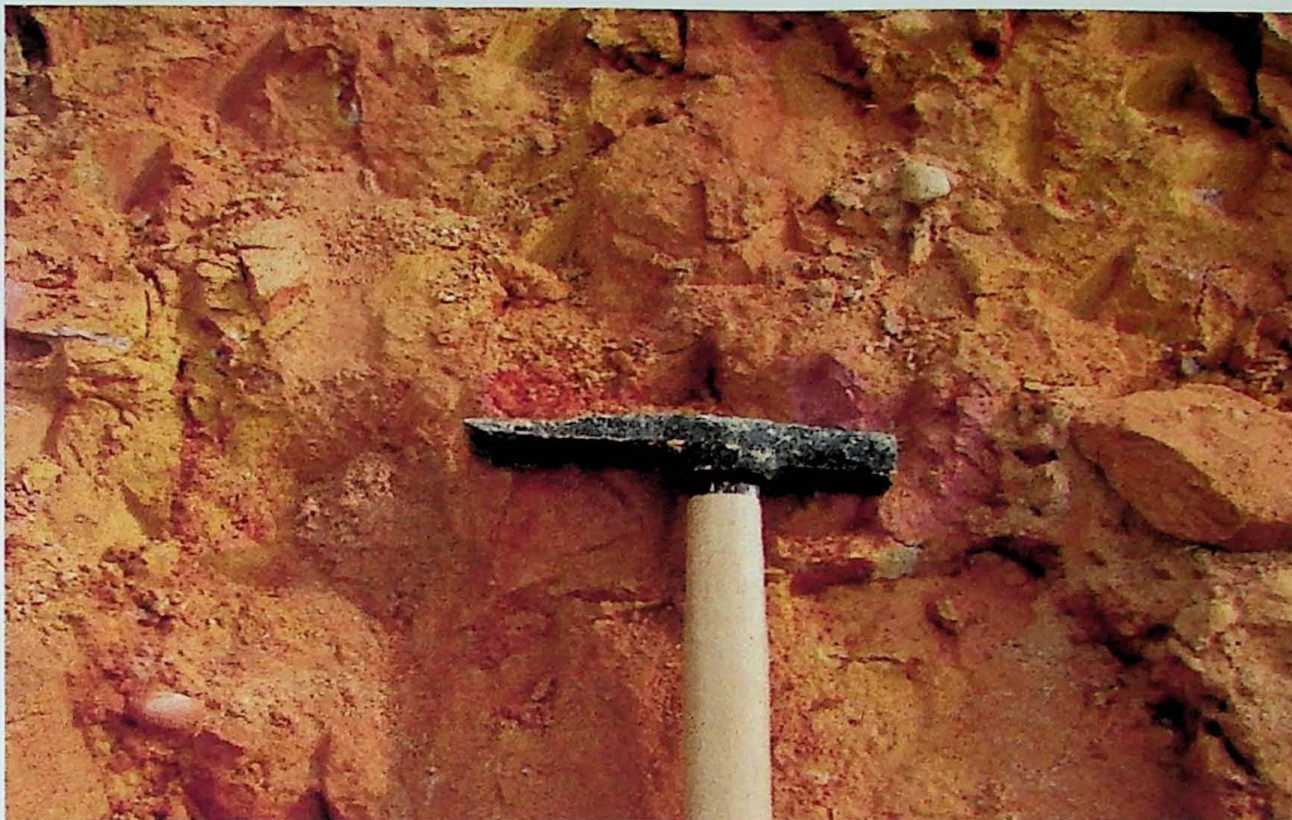
Foto 22-01 Diamictito silto arenoso muito alterado.
