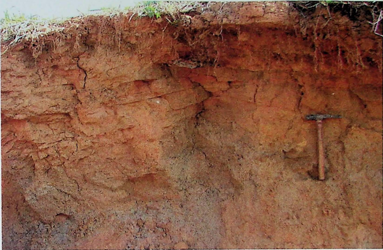
Foto 13-01 Diamictito arenoso, lenticular e estratificado, com poucos clastos dispersos na matriz.
