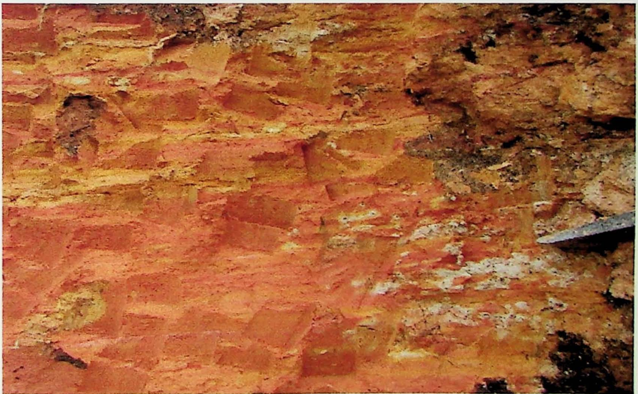
Foto 24-02 Siltito intercalado com lâminas de arenito fino, apresentando laminação horizontal.
