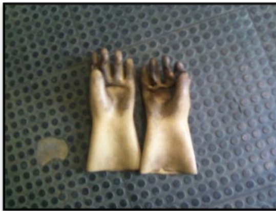
Figura 31 – Detalhe luva de alta danificada estação B Fonte: Arquivo pessoal (2012)
