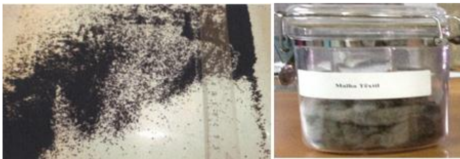
Figura 16. Produtos da Fase 3 (pó de borracha de 1 mm e material têxtil). (Fonte: Reciclanip)
