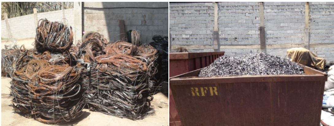
Figura 44 Aço proveniente da destalonagem – Policarpo Figura 45 Aço recuperado pós trituração - UTEP
