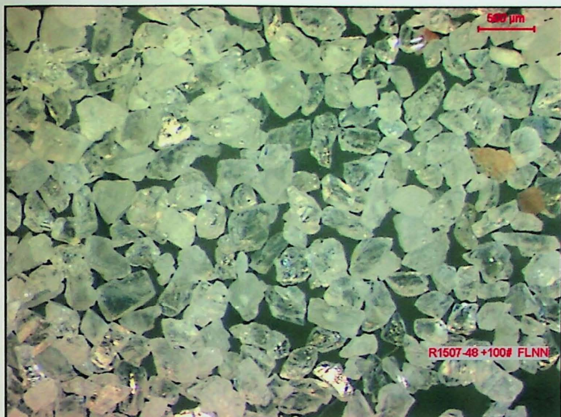
FIGURA 9.1: Partículas de carbonatos. Amostra R1507 (-48+100#), produto flutuado não magnético
