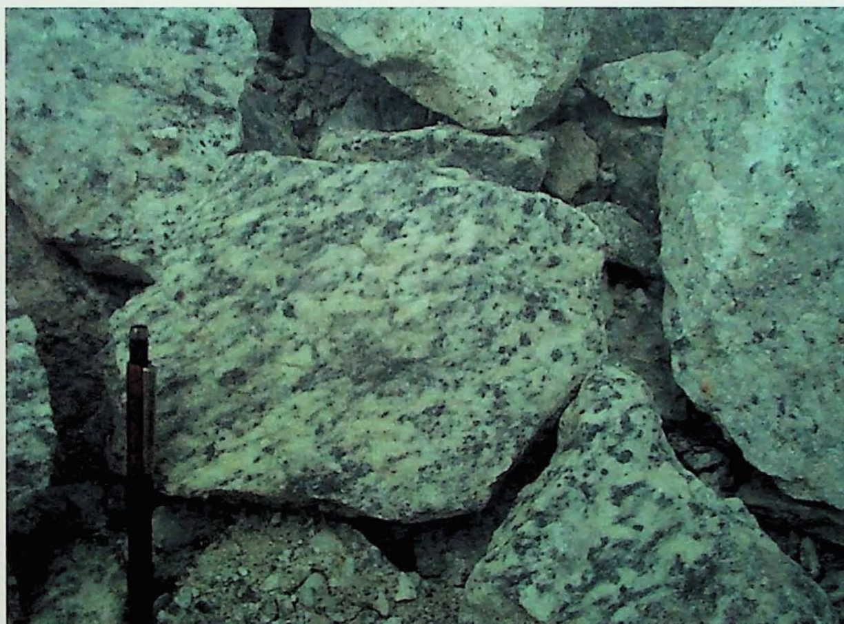
Figura 7.10 (B-50FL79/1): Rocha com muita apatita, olivina e magnetita da região centro sul da mina, utilizada apenas na composição da pilha 1520.
