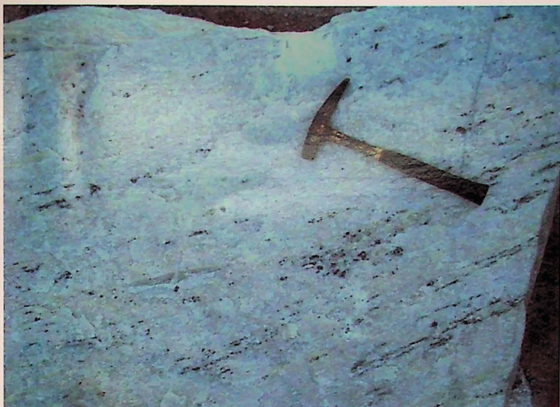
Figura 7.3 (B-60FL31/3): Porção da frente de lavra 31/3 pobre em acessórios, exibindo orientação mineral.
