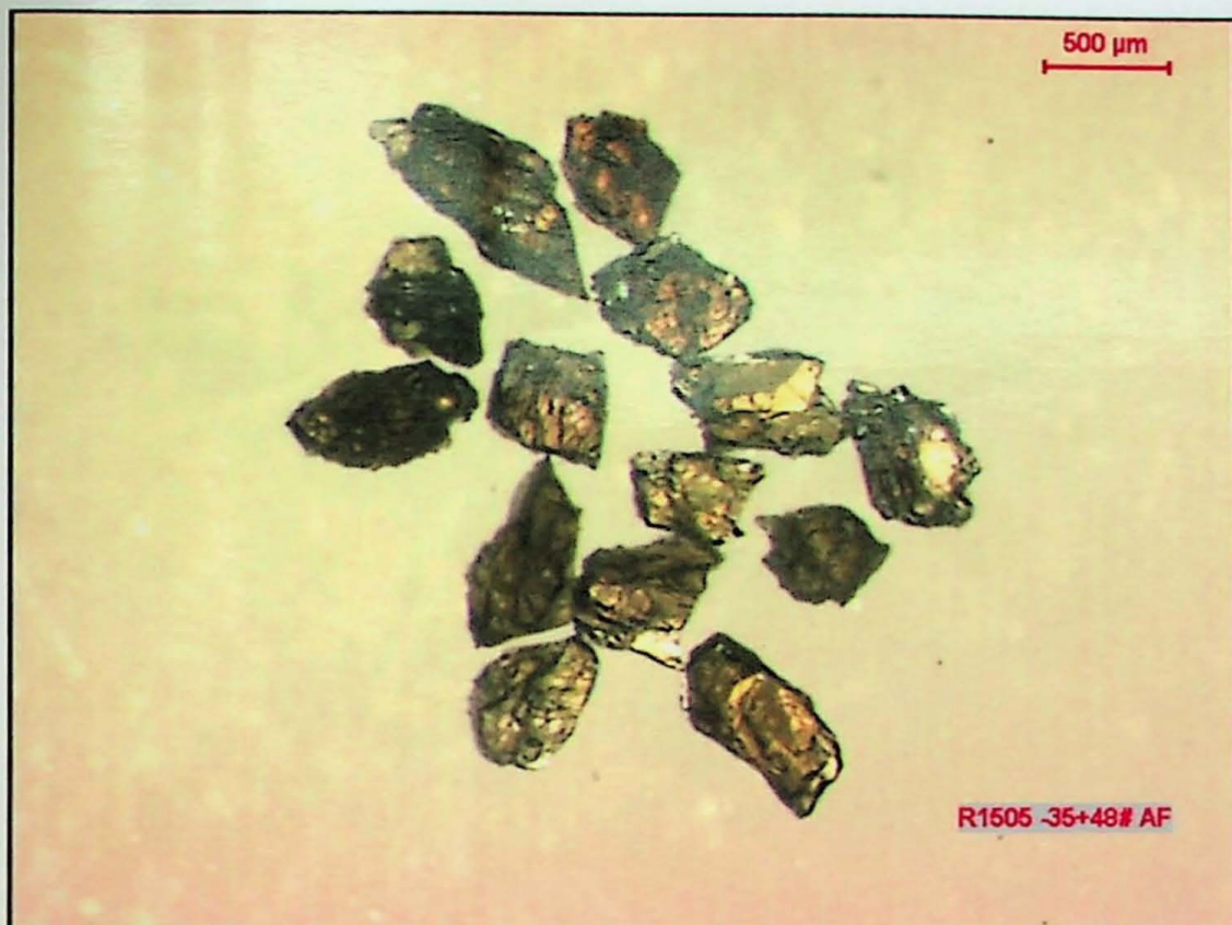
Figura 9.5: Partículas de olivina. Amostra R1505 (-35+48#), produto afundado em meio denso TBE ( d=2,96 \text{ g/cm}^3 )
