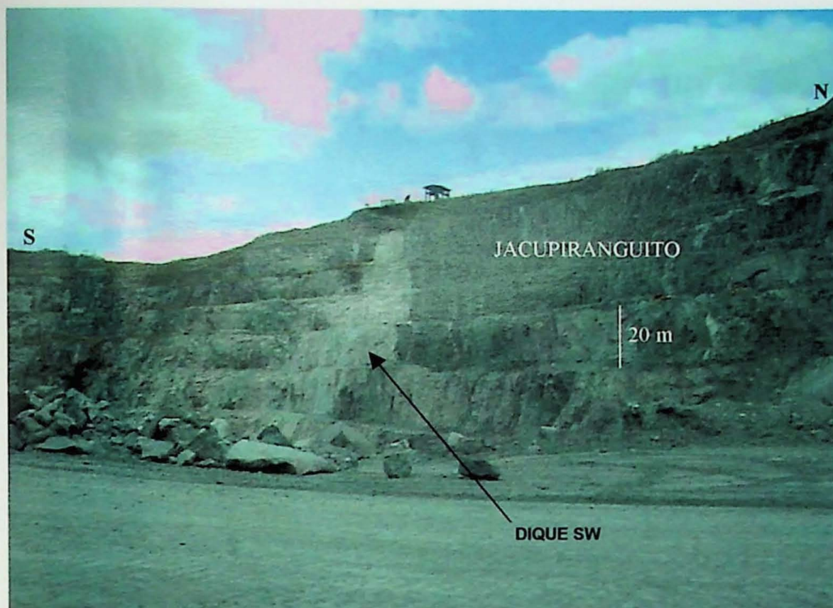
Figura 7.5 (DIQUE SW): Carbonatito periférico (Bonás, 2001) na região sudoeste da mina. Frente de lavra com alta contribuição de silicatos (olivina e flogopita) no teor total de magnésio.
