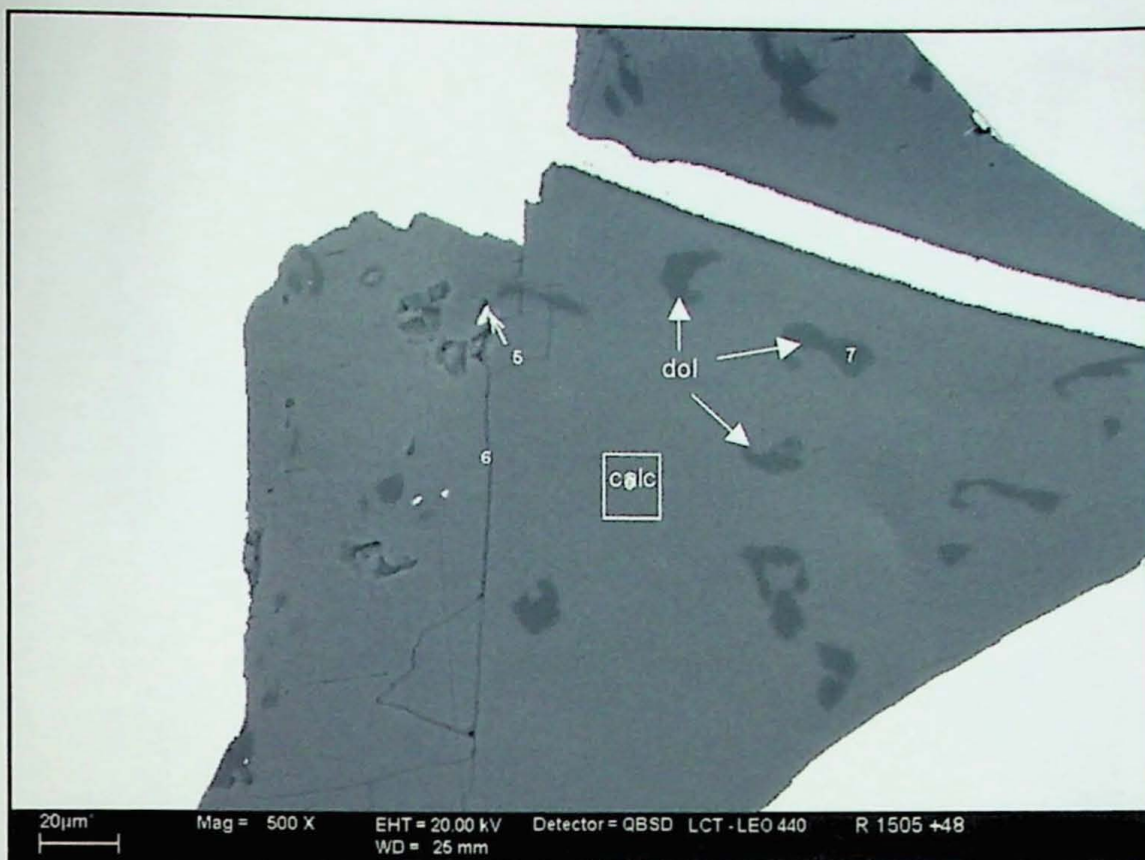
Figura 8.3: Exsoluções de dolomita (cinza escuro) na calcita. Amostra R1505 (-35+48#)
