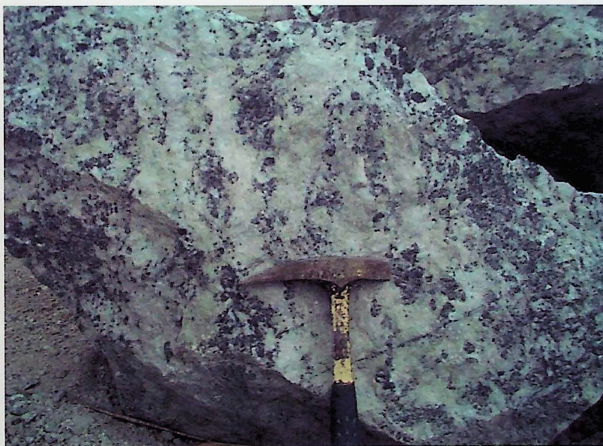
Figura 7.8 (B10FL461): Detalhe da estrutura bandada do carbonatito com intercalações de níveis ricos em olivina e magnetita e níveis com muita apatita.
