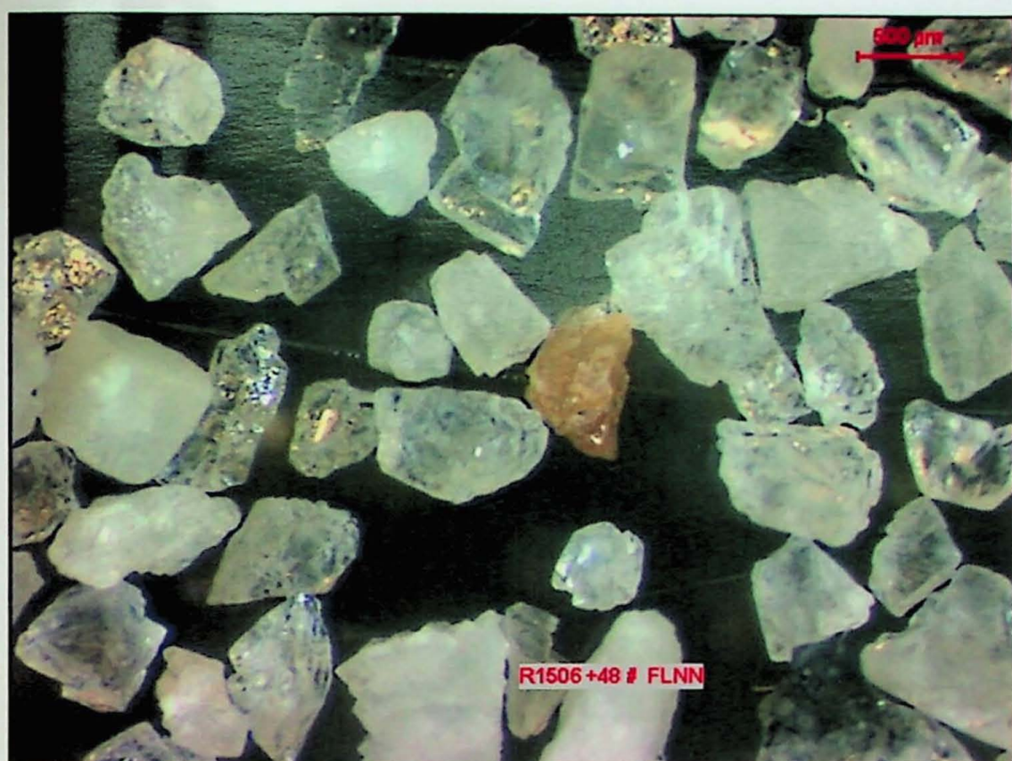
Figura 9.3: Partículas de carbonatos, notar carbonato cor laranja no centro da imagem. Amostra R1506 (-35+48#), produto flutuado não magnético
