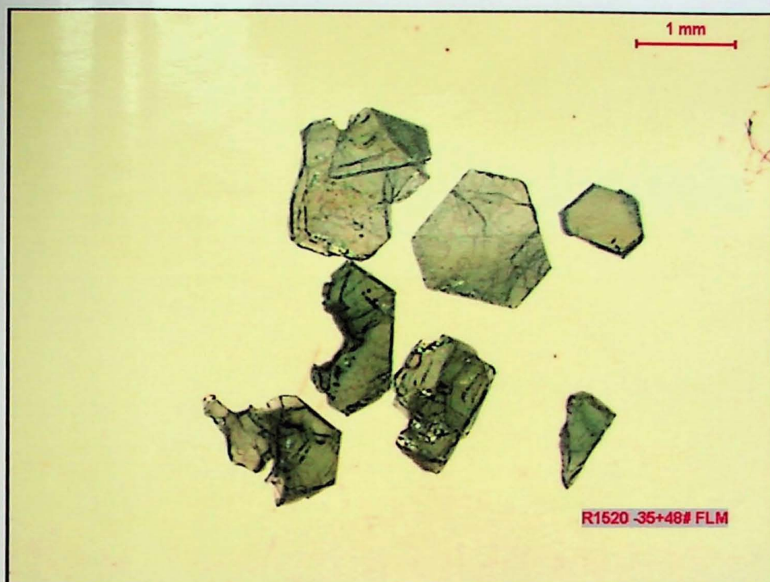
Figura 9.7: Partículas de flogopita. Amostra R1520 (-35+48#), produto flutuado ( d < 2,96 \text{ g/cm}^3 ) magnético (1,3 A)
