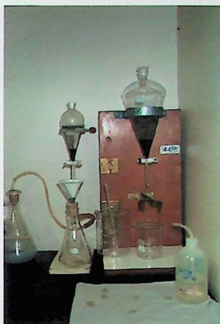
Figura 4.2: Ensaio em meio denso
