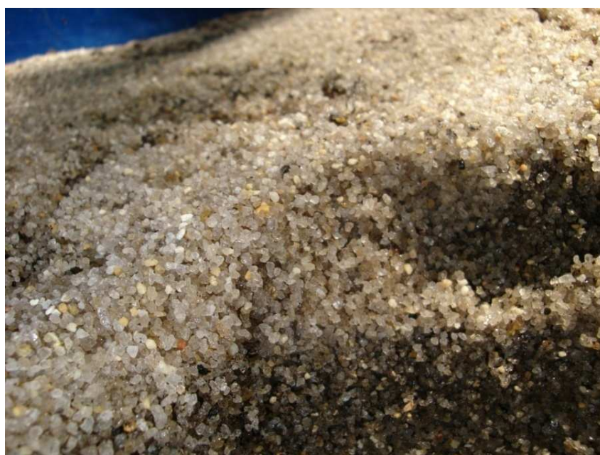
Figura 10- Detalhe da camada de areia utilizada originalmente.
