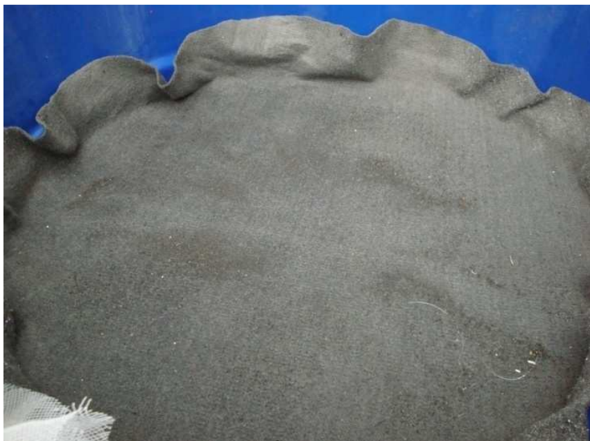
Figura 13 - Geotêxteis instalados na caixa d'água.
