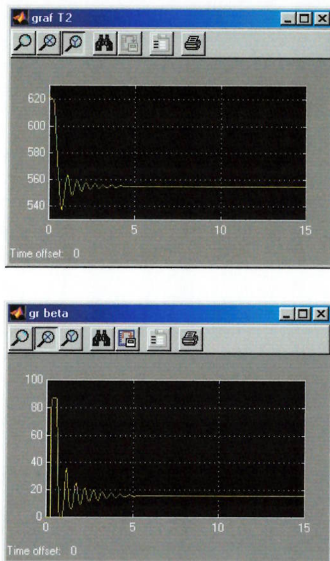
Figura 5.8: Comportamento da temperatura de saída e posição do atuador da válvula usando a constante de mola K=6700\text{N/m} e pré-carga de mola 63N.
