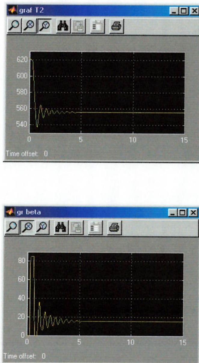
Figura 5.9: Comportamento da temperatura de saída e posição do atuador da válvula usando a constante de mola K = 6700\text{N/m} e pré-carga de mola 66N.
