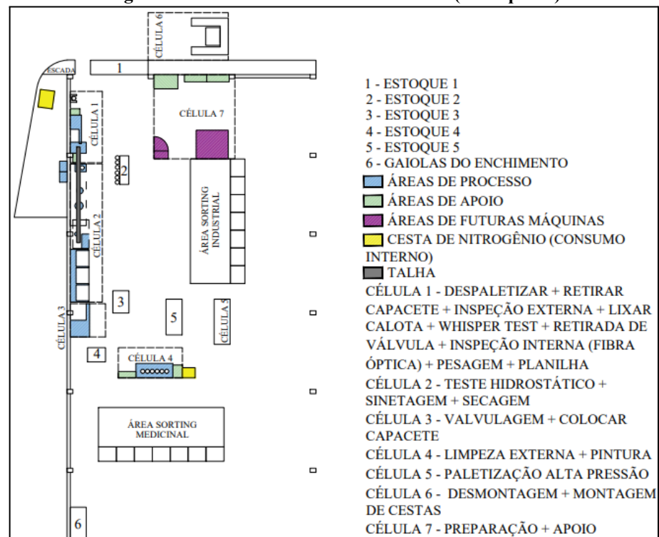
Figura 15 - Conceito 2 fábrica de cilindros (curto prazo)
