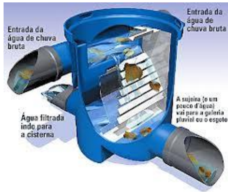
Figura 33: detalhe do filtro de águas pluviais
