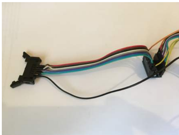
Figura 22: Conector TXS0108E - saída para estimulador
