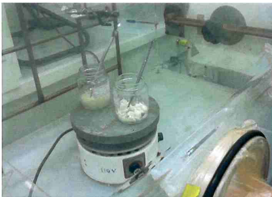
Figura 9 – Frascos com misturas poliméricas sobre a chapa de aquecimento dentro da glove box .
