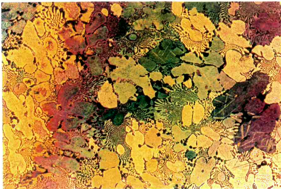
Fig.13 - Liga ZAMAK 5 – microestrutura
