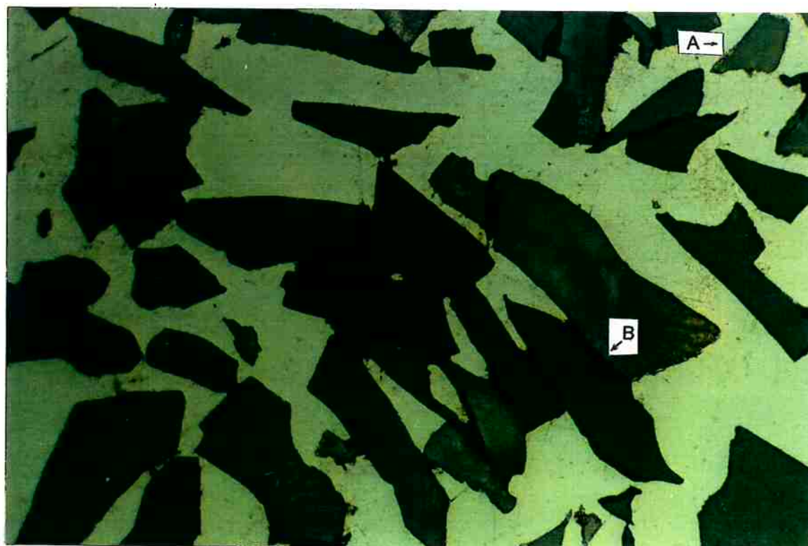
Fig. 16 - Defeitos de Infiltração
