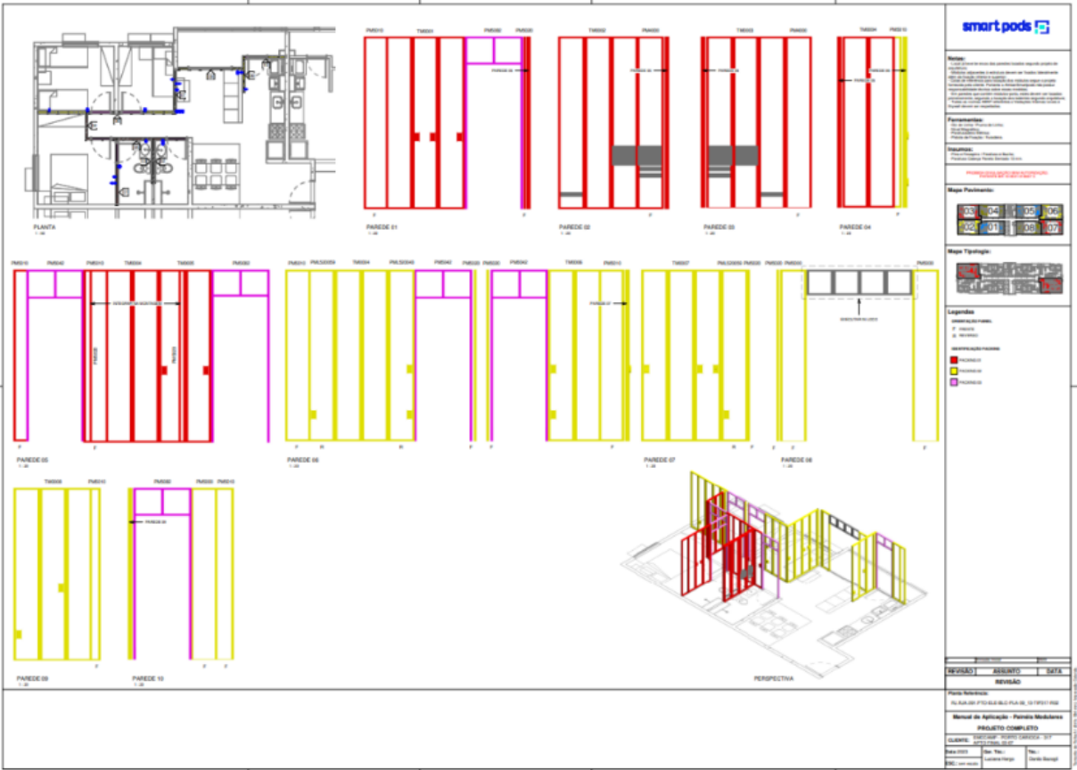
Figura 19 - Projeto com os módulos identificados com as cores das etiquetas entregues
