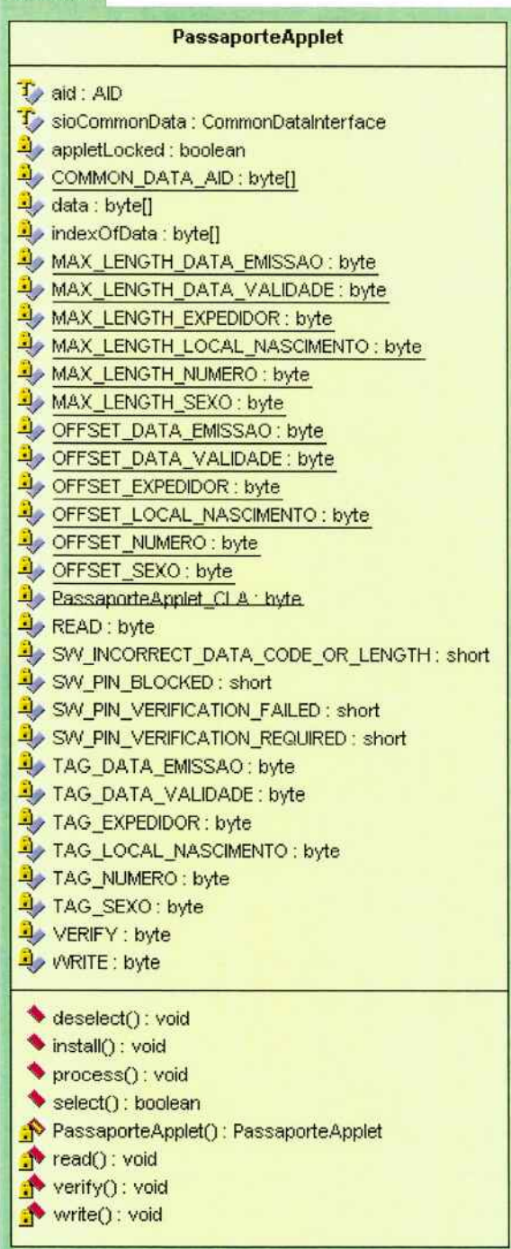
Figura 15 - Diagrama UML do applet Passaporte
