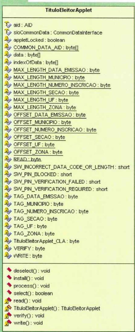
Figura 14 - Diagrama UML do applet TituloEleitor
