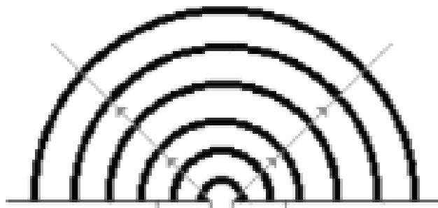
Figura 6- Propagação do som em onda semi-esférica.
