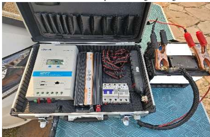
Figura 13 – Painel controlador utilizado para amostragem de água subterrânea.
