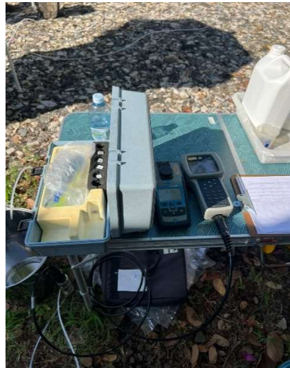
Figura 14 – Conjunto de amostragem de água por baixa vazão ( Low Flow ) utilizado em campo.
