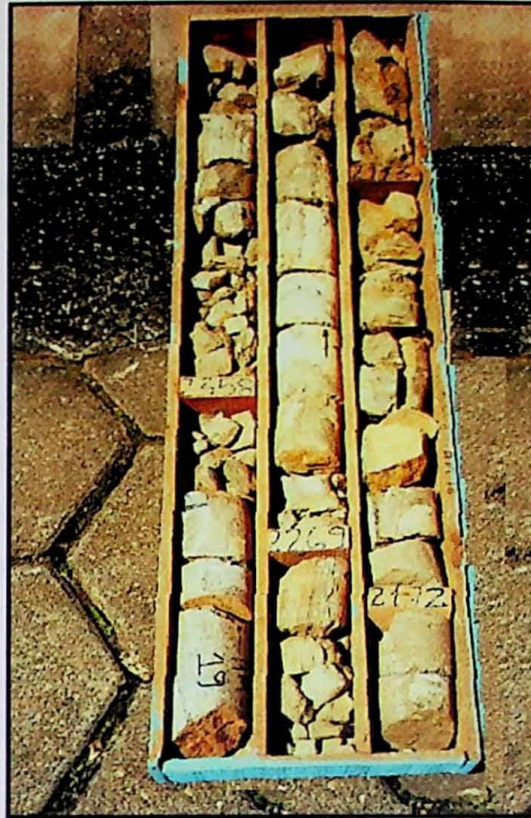
FOTO 12 – Caixa de testemunhos de sondagem apresentando manobras com baixos valores de RQD e recuperação. (SR-03, caixa nº 06).
