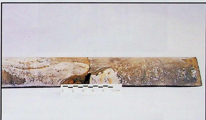
FOTO 11 – Quebra mecânica em gnaiss bandado, no detalhe observar o encaixe perfeito entre as duas peças. (SR-03, caixa nº08).
