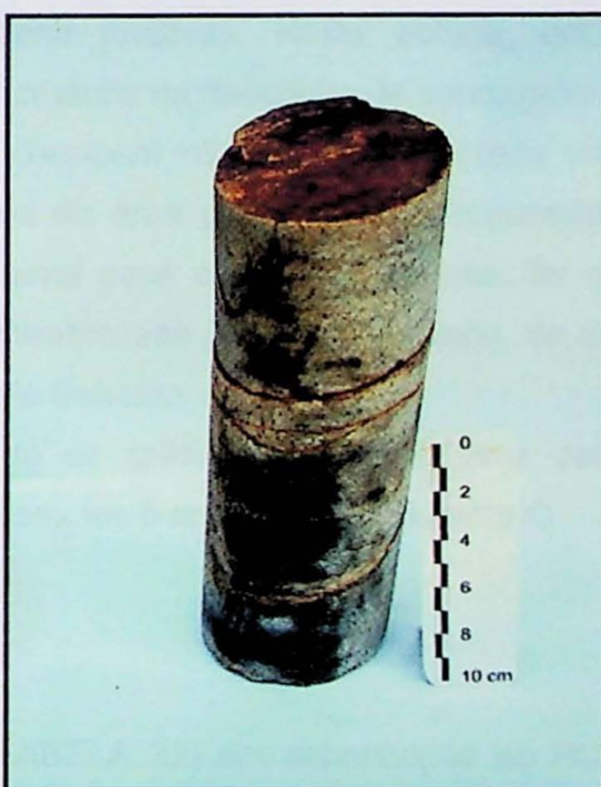
FOTO 17 – Fraturas subhorizontais com alteração incipiente e com preenchimento de material oxidado (SR-01, caixa nº 04).
