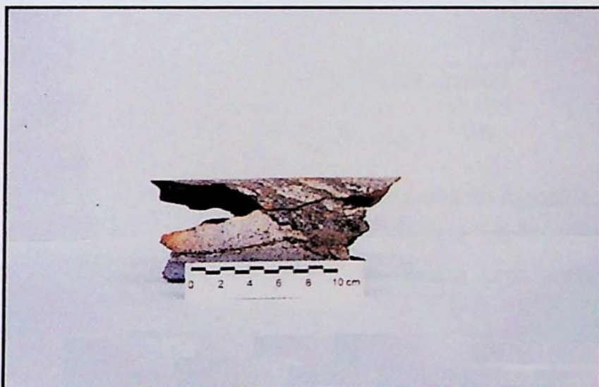
FOTO 13 – Perfil da rugosidade (R8/R9) em fratura subvertical, gnaiss bandado (SR-06, caixa nº 09).
