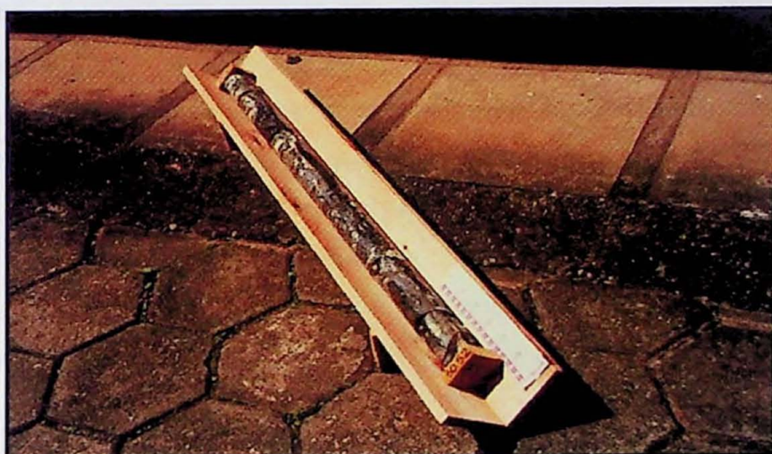
FOTO 7 – Montagem da manobra 29,22/30,52m do furo SR-05, caixa nº08 (gnaisse biotítico).
