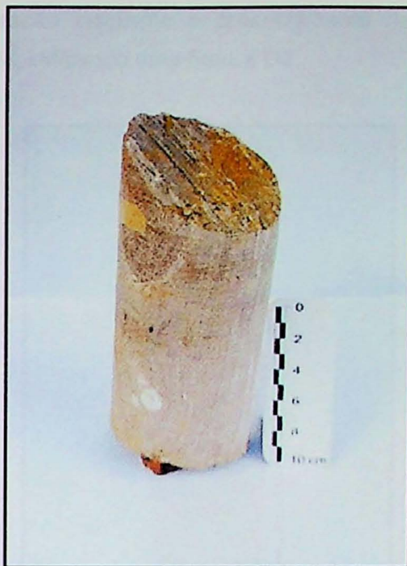
FOTO 15 – Fratura pouco rugosa (polida) e preenchida por material oxidado, filonito (SR-07, caixa nº 08).
