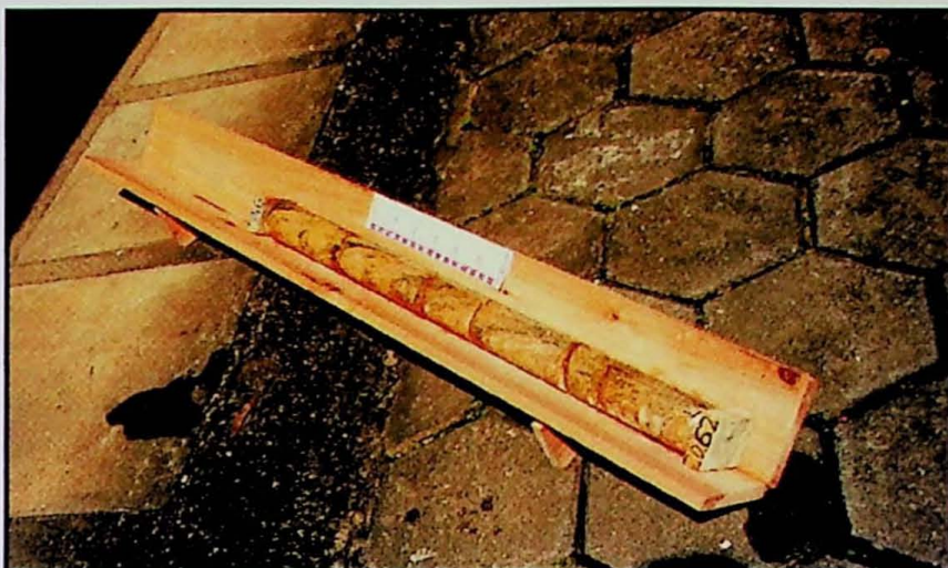
FOTO 8 – Montagem da manobra 19,56/20,62m do furo SR-01, caixa nº04 (gnaisse granítico).
