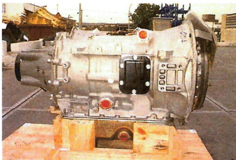
Figura 2.3(a) - Transmissão Automática modelo MT 643
