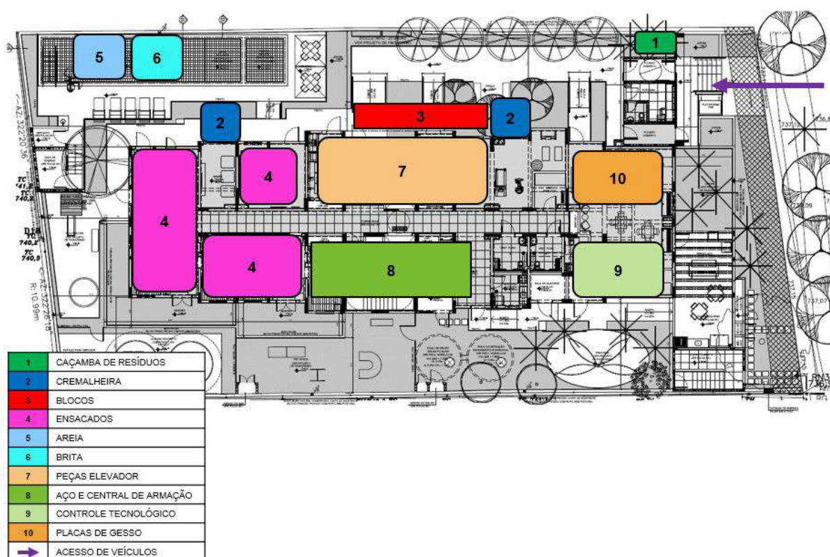
Figura 33 - Projeto de Canteiro Fase Acabamento - Caso A
