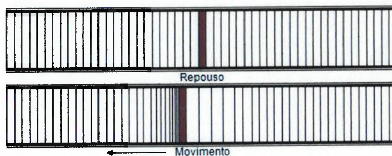
Figura 2 - Deslocamento longitudinal do som.
