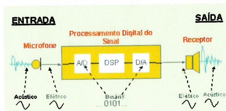
Figura 10 - Diagrama em bloco da prótese e auditiva digital Fonte: www.widex.com.br
