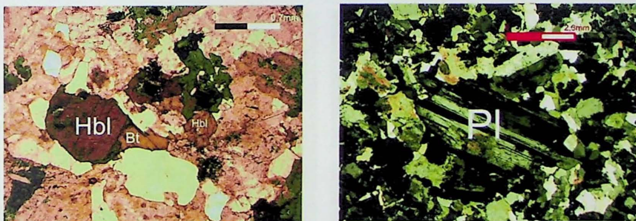
Foto 17: Aspecto microscópico do granodiorito Fofóquina. A foto da esquerda mostra os minerais máficos acessórios, como a hornblenda (Hbl) e biotita (Bt). A foto da direita mostra o megacristal de plagioclásio, mineral com maior percentagem na rocha.
