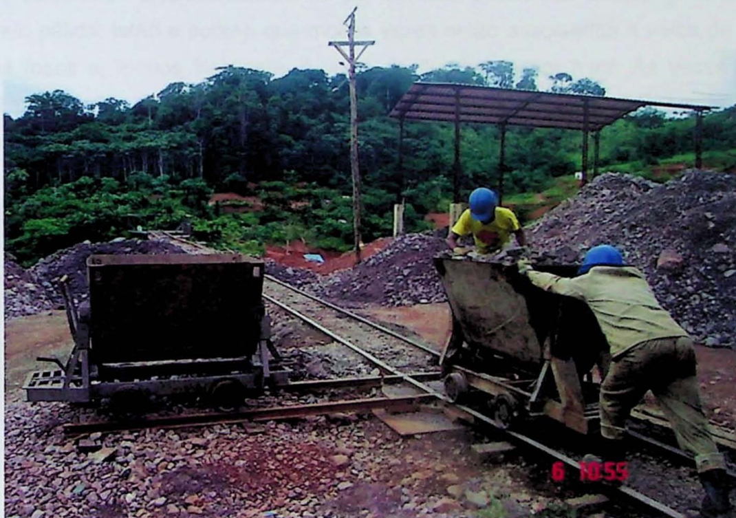
Foto 02: Remoção de minério até o local do empilhamento
