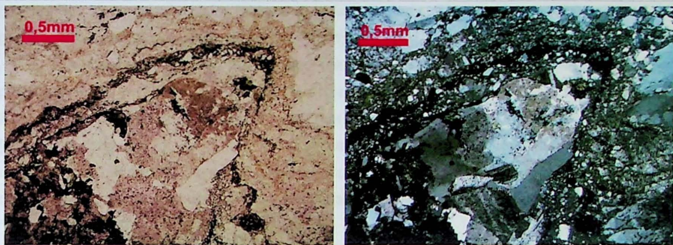
Foto 23: Aspecto microscópico do cisalhamento afetando o Granito Palito hidrotermalizado. Notar a fragmentação do feldspato potássificado, com porção túrbidas, que atestam que a alteração hidrotermal precedeu as zonas de cisalhamento.
