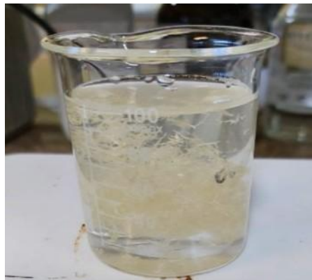
Figura 7 – Teste do lixiviamento da Luffa cylindrica
