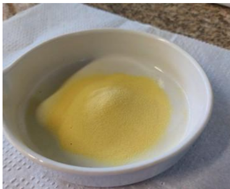
Figura 16 - Nitreto de carbono grafitico impregnado em sílica gel- \text{g-C}_3\text{N}_4/\text{SiO}_2 .
