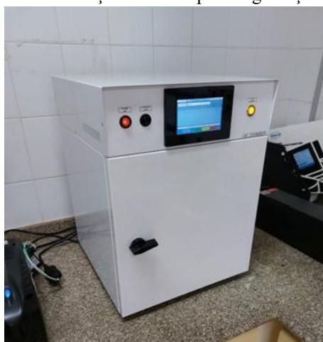
Figura 8 – Câmara de radiação utilizada para degradação em UV-A LED
