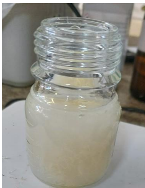
Figura 6 – Processo de impregnação da bucha com g-C 3 N 4
