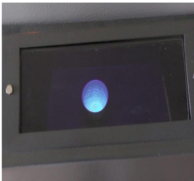
Figura 9 - g-C 3 N 4 após retirada da mufla, exposto em câmara UVA.
