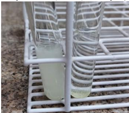
Figura 17 - Teste do lixiviamento para a sílica (à direita) em comparação com o \text{g-C}_3\text{N}_4 (à esquerda).
