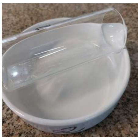
Figura 13 - Placa de vidro após primeiro banho em suspensão de g-C_3N_4 .
