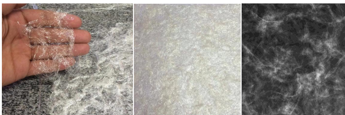
Figura 8: (a) Produção do objeto simulador utilizando várias camadas de filme PVC (b) Aspecto do objeto final sem recortes sobre uma superfície branca (c) Imagem Radiográfica do objeto.
