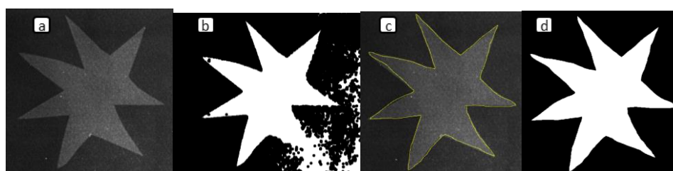
Figura 29: (a) ROI da imagem radiográfica do objeto de teste de forma distorção de arquitetura de folha PVC; (b) Segmentação automática; (c) Contorno do especialista; (d) Imagem Binária do contorno do especialista.
