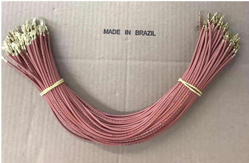
Imagem 4: Circuito de silicone pronto, Fonte: O autor
