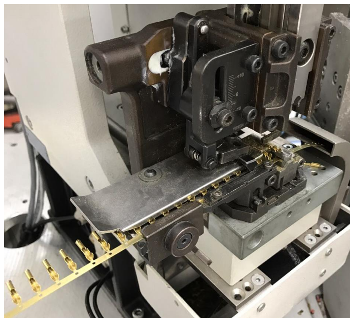
Imagem 5: Mini – aplicador usado na crimpagem de terminais, Fonte: O autor
