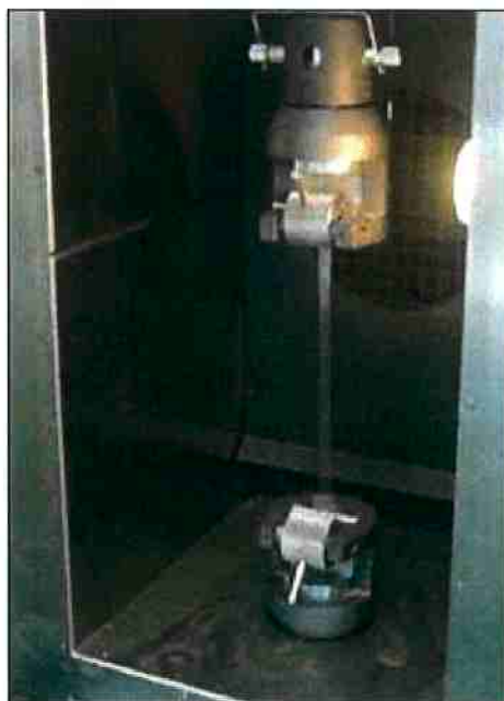
Figura 12: Câmara de aquecimento da INSTRON, modelo 5567.
