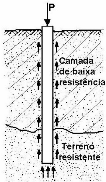
Figura 5.4.10: Distribuição das cargas em uma estaca
