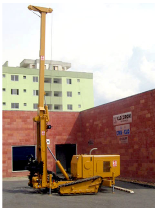
Figura 5.4.24: Equipamento utilizado na execução da estaca raiz
