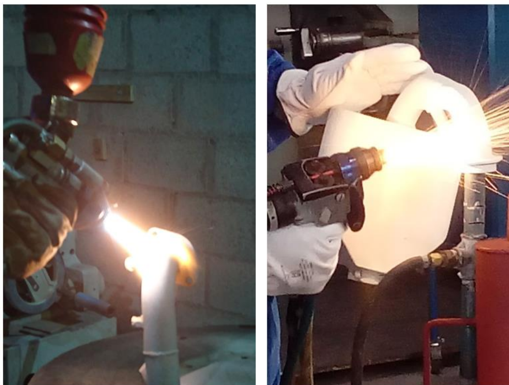
Figura 46 - Deposição por meio do processo HVOF (à esquerda) e HVCW (à direita)
