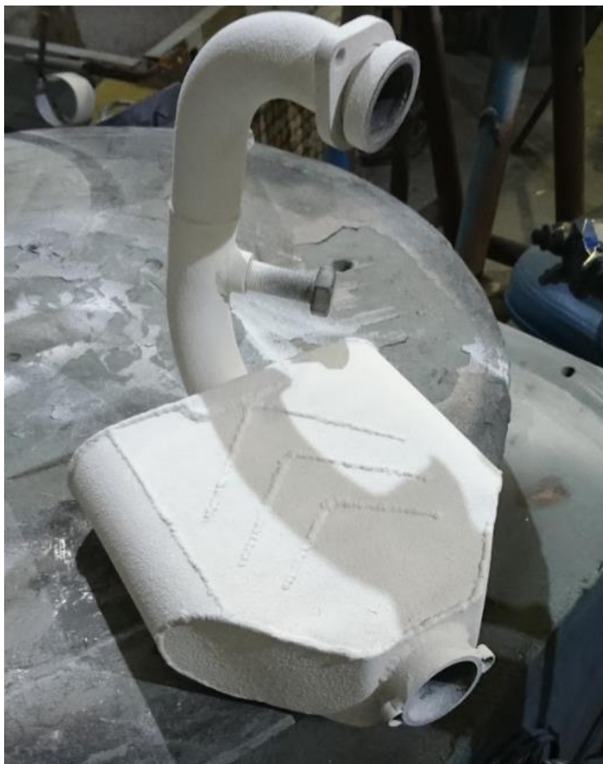
Figura 51 - Segundo revestimento cerâmico de MSZ depositado e sistema TBC finalizado sobre o sistema de exaustão
