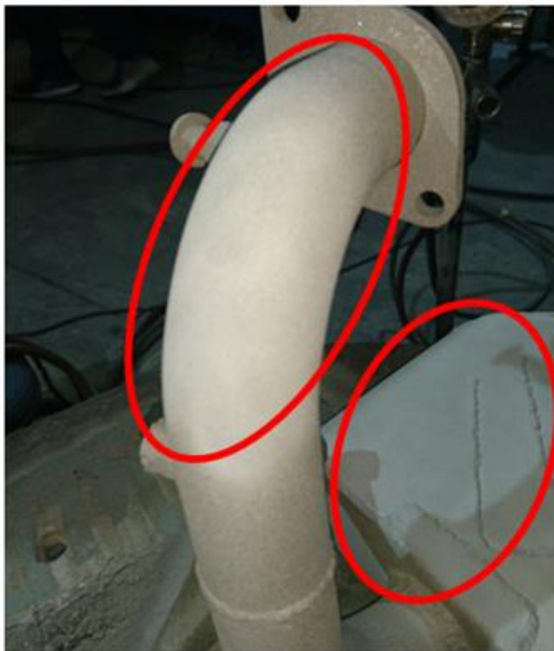
Figura 50 - Primeiro revestimento cerâmico de YSZ, onde as regiões destacadas em vermelho são os locais críticos que receberam camada de maior espessura
