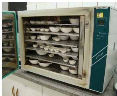
Figura 4.4: Estufa utilizada nas análises
