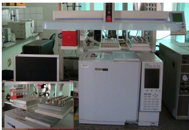
Figura 4.8: Cromatógrafo GC Shimadzu, utilizado na análise de álcoois e ácidos. Destaque para o local onde as amostras são armazenadas.
