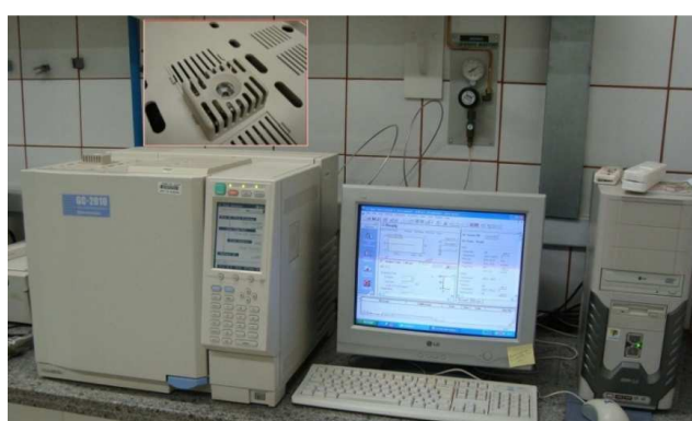
Figura 4.9: Cromatógrafo GC-Shimadzu, utilizado na análise de hidrogênio e de outros gases. Destaque para o local onde é efetuada a injeção do gás.
