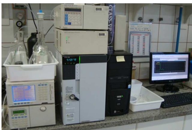
Figura 4.10: Conjunto Shimadzu de cromatografia líquida de alta eficiência (HPLC).
