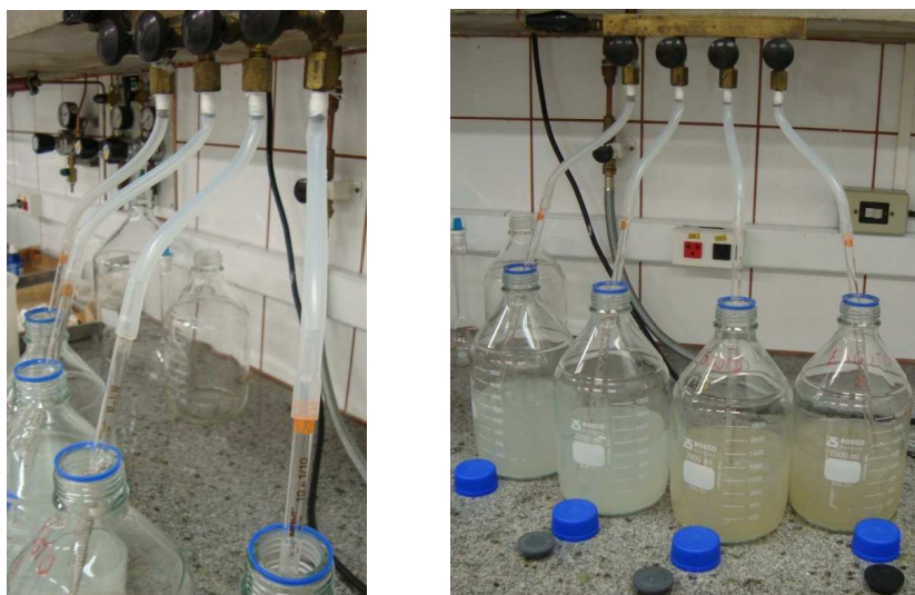
Figura 4.7. Fotos dos frascos sendo fluxionados com gás Argônio, possibilitando sua anaerobiose.
