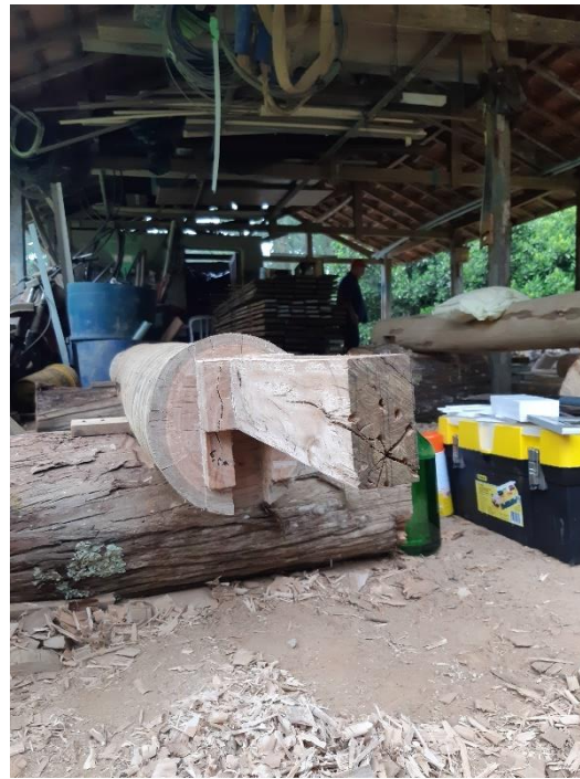
Figuras 67 e 68. Execução do encaixe da outra extremidade da vigia VA2. Fonte: Alexander Chang.
