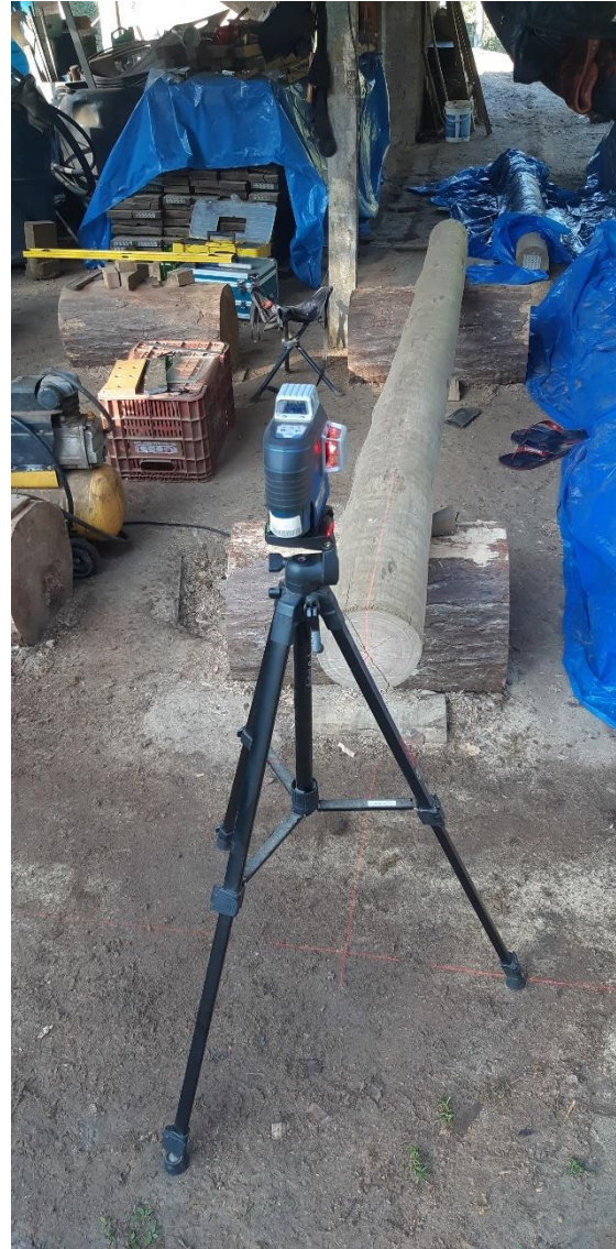
Figuras 111 e 112. Desbastamento e marcação da tora. Fonte: Alexander Chang.
