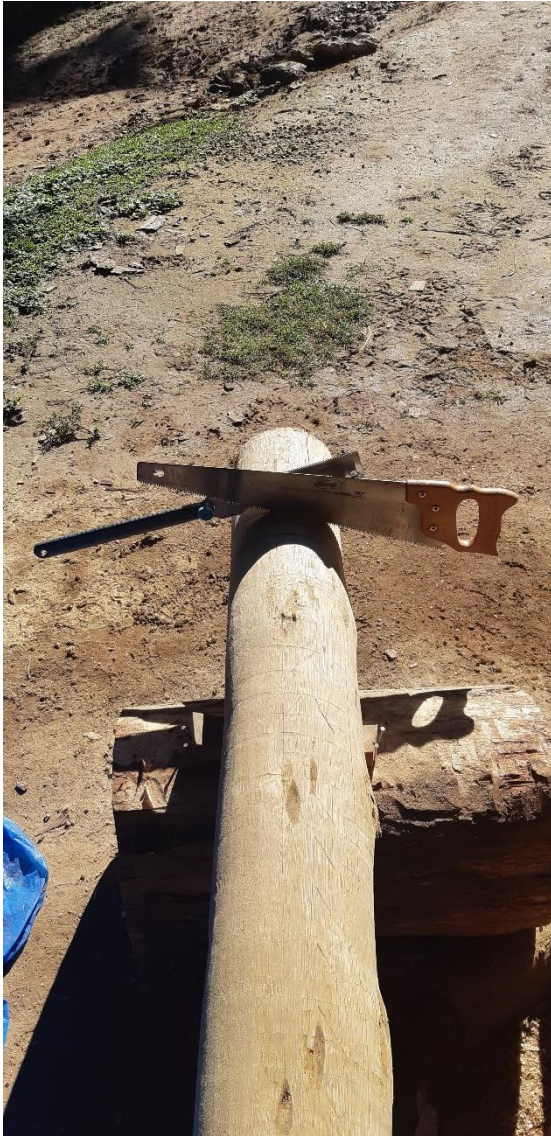
Figuras 113 e 114. Etapa de serragem da madeira para facilitar o uso do formão. Fonte: Alexander Chang.
