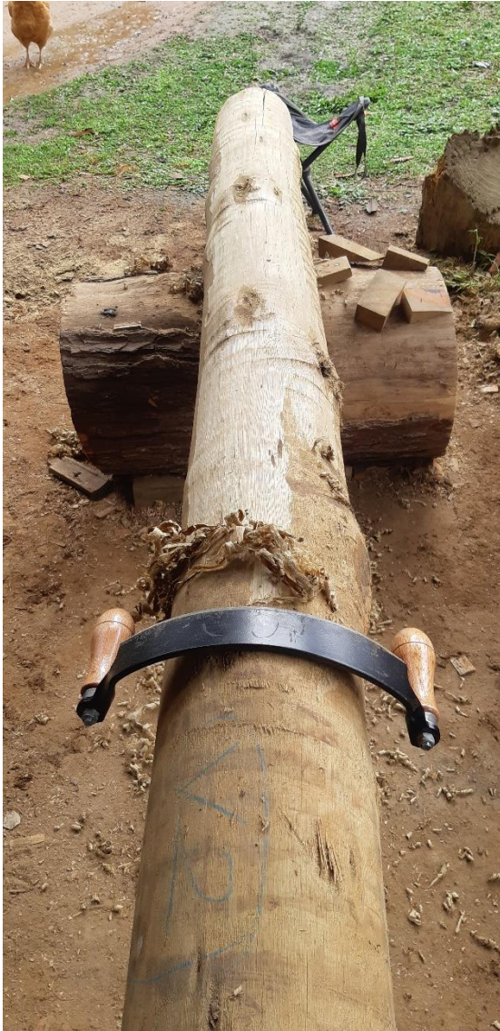
Figuras 111 e 112. Desbastamento e marcação da tora. Fonte: Alexander Chang.
