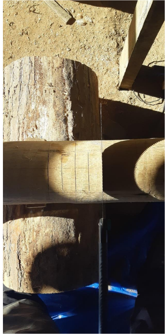
Figuras 113 e 114. Etapa de serragem da madeira para facilitar o uso do formão. Fonte: Alexander Chang.
