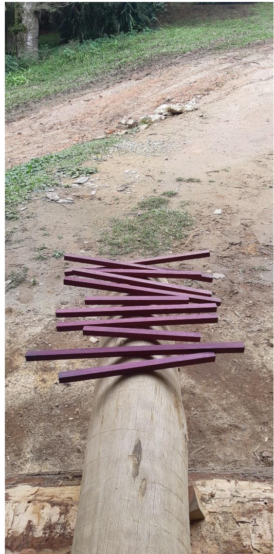
Figuras 123 e 124. Encaixe quase pronto e produção dos pinos de roxinho. Fonte: Alexander Chang.
