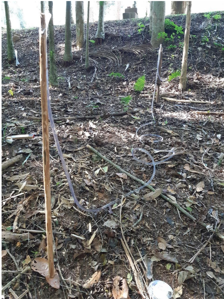
Figura 33. Levantamento topográfico com uma mangueira de nível. Fonte: Alexander Chang.
