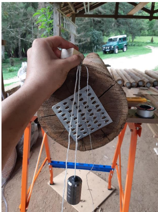
Figuras 50 e 51. Determinação de um eixo para a tora e marcação. Fonte: Alexander Chang.
