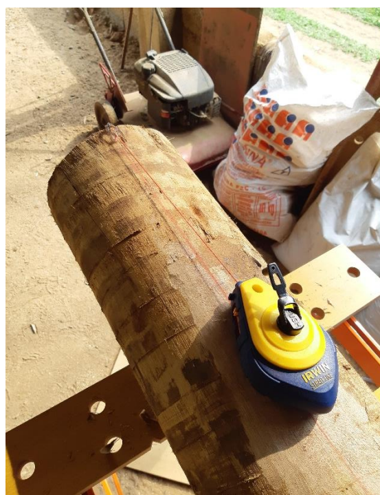
Figuras 50 e 51. Determinação de um eixo para a tora e marcação. Fonte: Alexander Chang.
