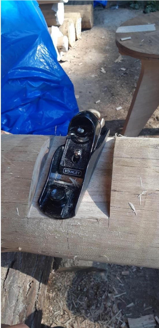
Figuras 117 e 118. Uso da plaina block e desenho do encaixe. Fonte: Alexander Chang.
