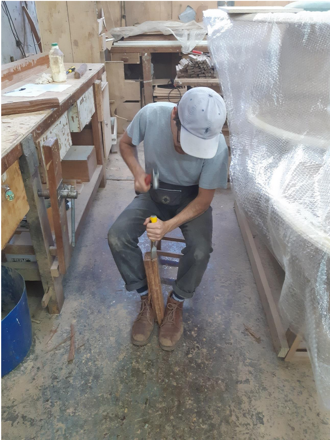
Figura 12. Caio Cintra usinando o pé do banco, evidenciando as fibras da madeira. Fonte: Alexander Chang.
