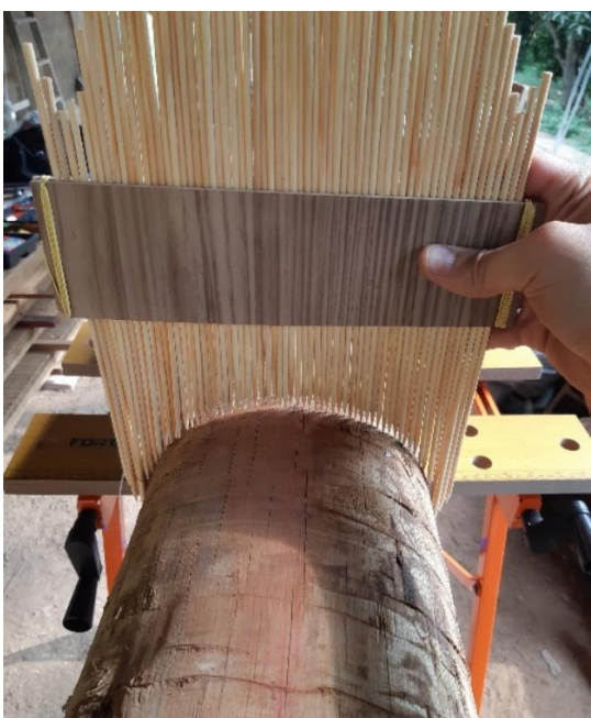
Figuras 52 e 53. Transporte das medidas do desenho para a curvatura da tora. Fonte: Alexander Chang.
