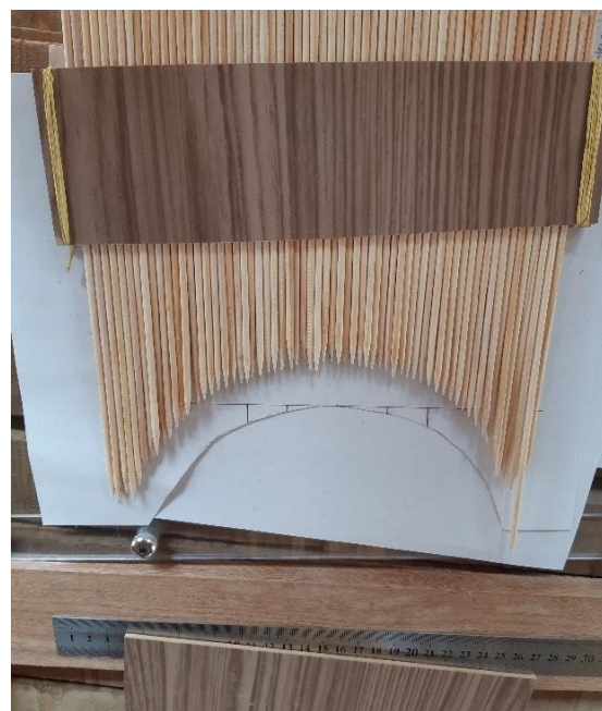
Figuras 52 e 53. Transporte das medidas do desenho para a curvatura da tora. Fonte: Alexander Chang.
