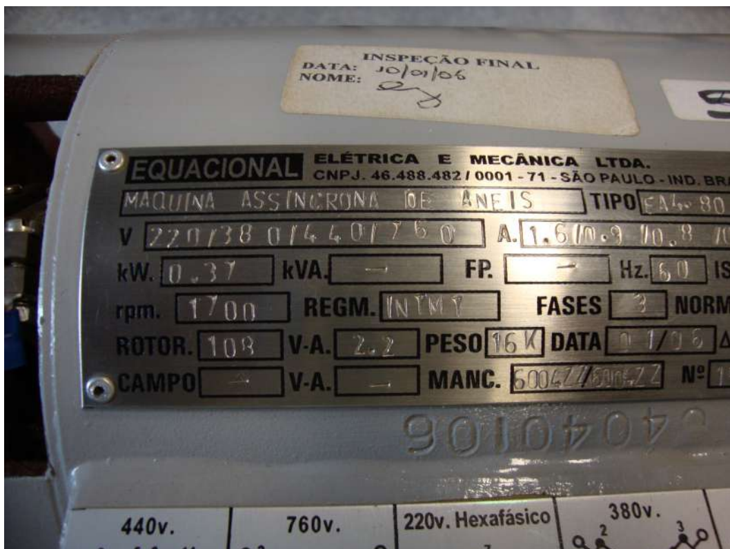
Figura 3.14: Chapa com dados do motor de indução (1ª parte).
