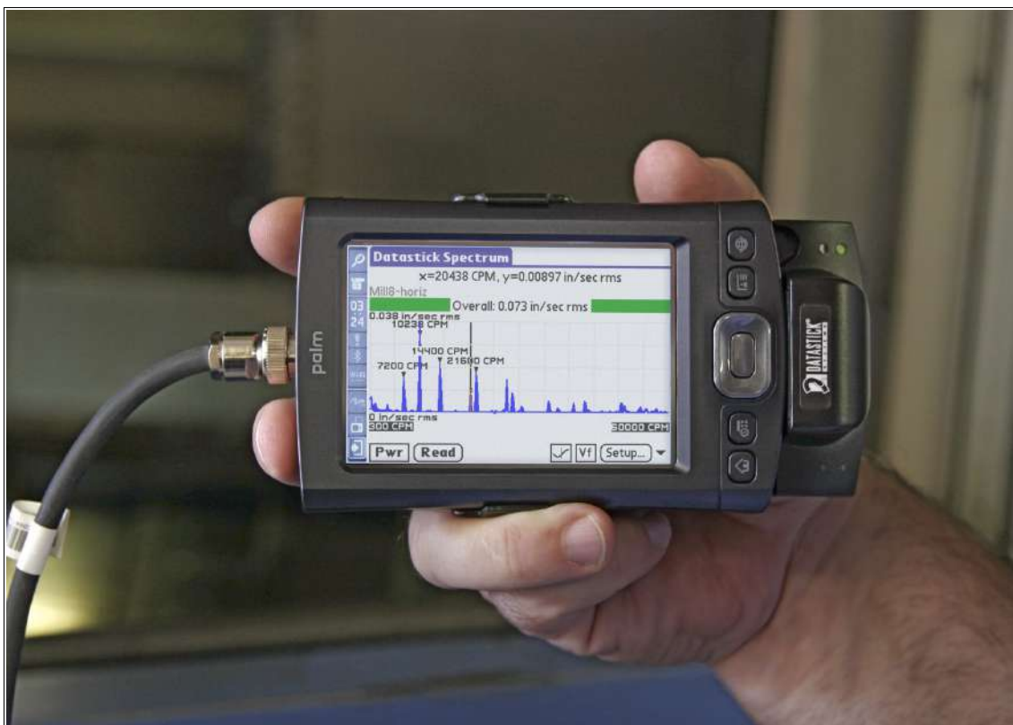
Figura 1.3: Analisador e coletor de dados de vibração VSA-1215, da Datastick System.
