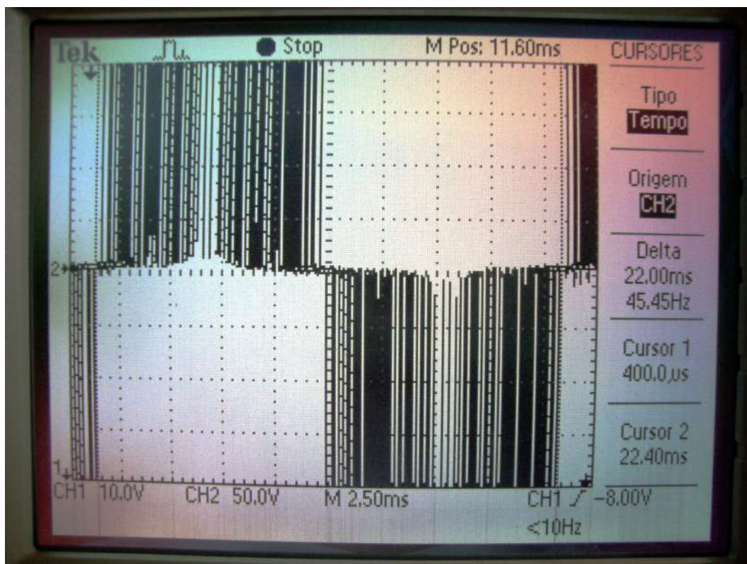
Figura 3.21: Forma de onda da saída do inversor de frequência em 45,6Hz.
