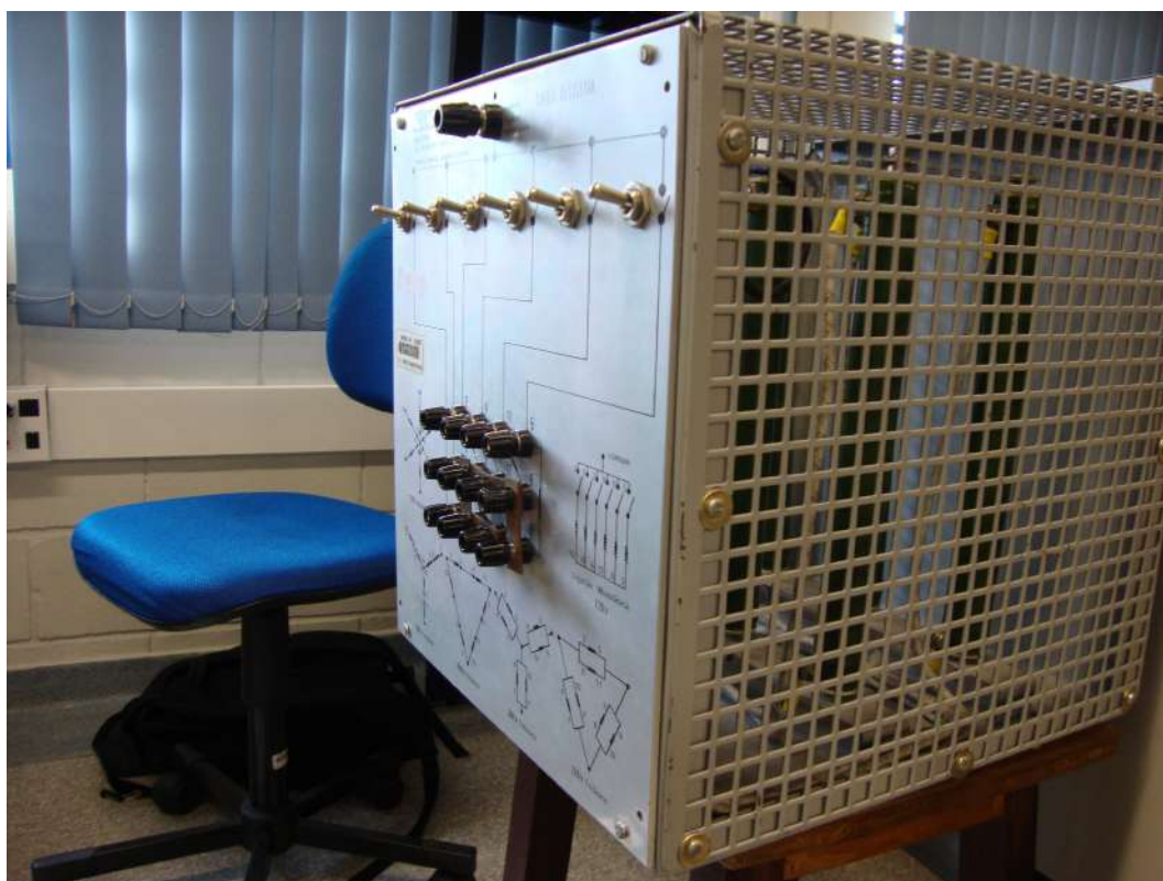
Figura 3.18: Carga resistiva para testes do motor de indução (lateral).
