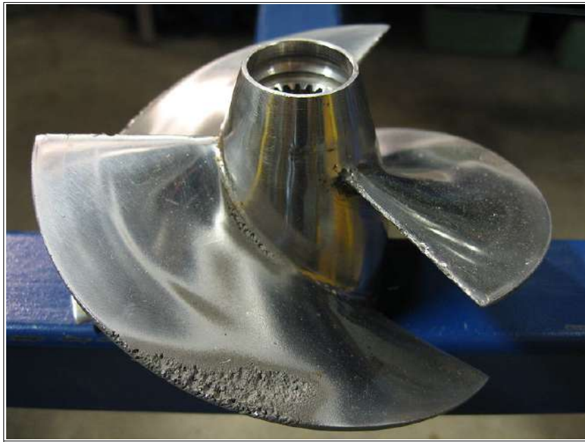
Figura 1.2: Hélice desgastada pelo processo de cavitação.
