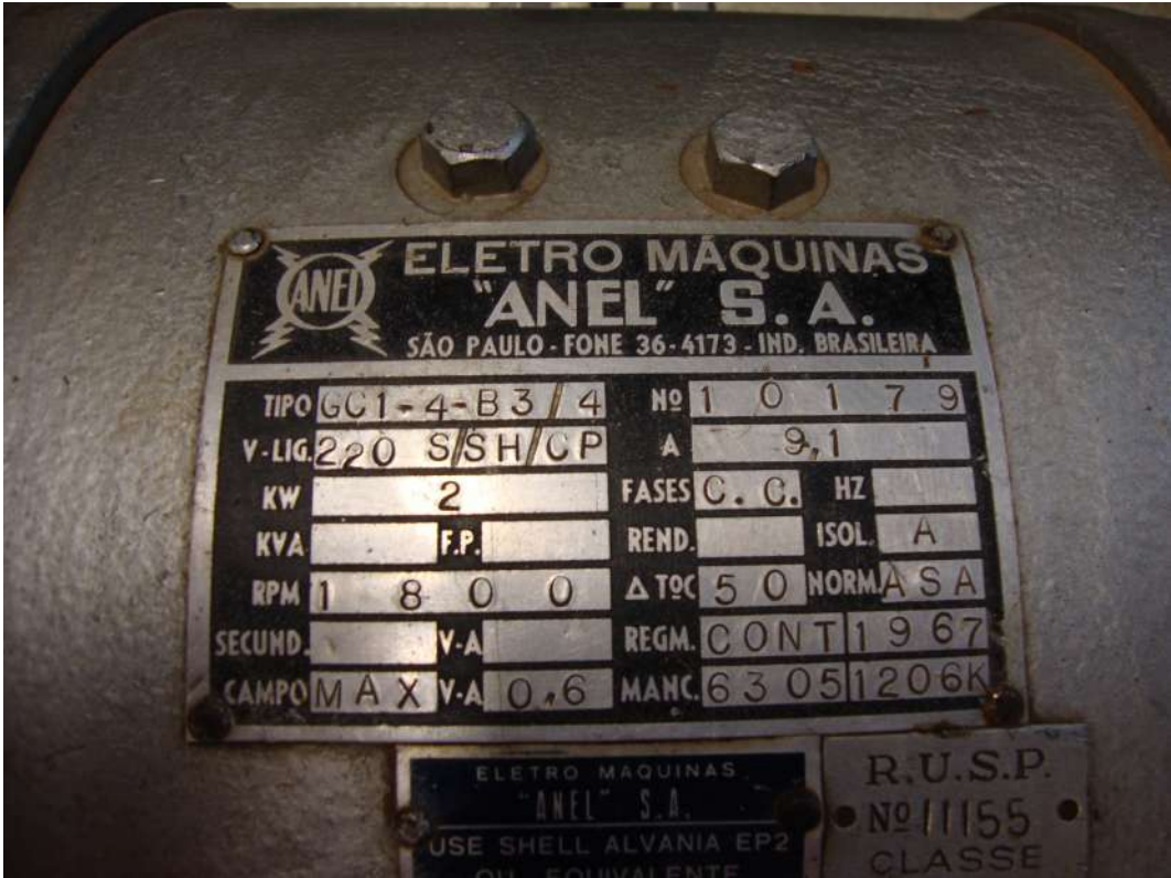
Figura 3.6: Chapa com dados do motor DC de 1700W.
