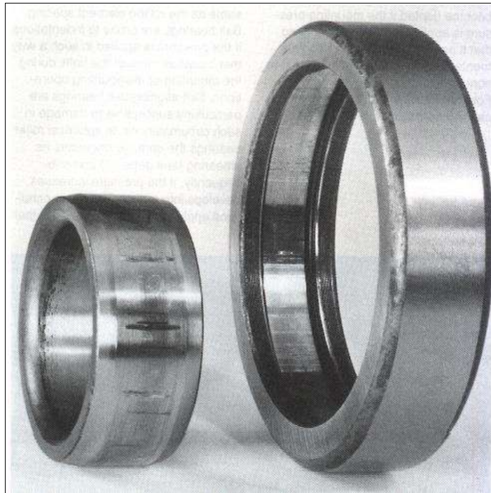
Figura 1.1: Anéis de um rolamento de rolos cilíndricos.
