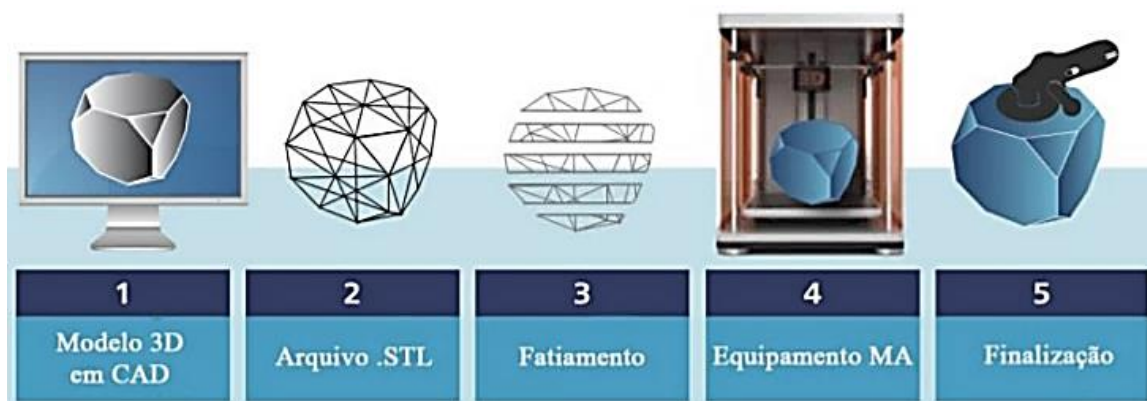
Figura 5 – Etapas de processo de manufatura aditiva
