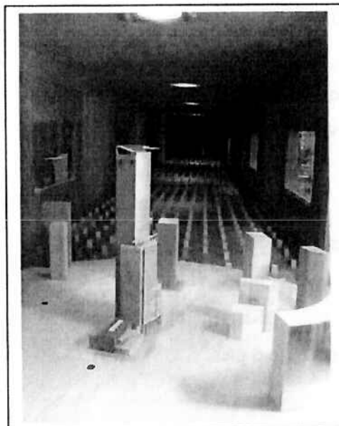
Figura 5 – Maquete para ensaio no túnel de vento
