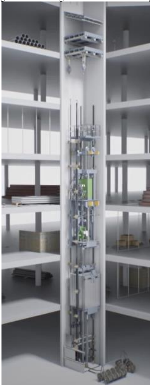
Figura 51 - Montagem de elevador em 2 etapas
